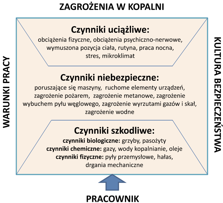
Rys. 19. Czynniki niebezpieczne, szkodliwe i uciążliwe w kopalni podziemnej
