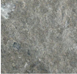
a) skała makroskopowa wymiar bloku ok. 0,5 m x 0,5 m x 0,5 m b) próbki walcowe h=80 mm, d=40 mm
