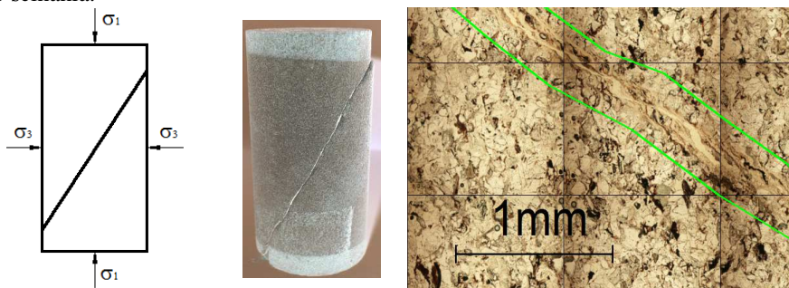
Rys. 6.8. Mechanizm zniszczenia w warunkach trójosiowego ściskania oraz odpowiadające mu na obrazie mikroskopowym pasmo ścinania (piaskowiec Wustenzeller)
