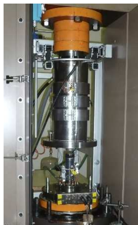
Rys. 3.1. Maszyna wytrzymałościowa MTS-815 Rock and Concrete Mechanics Testing System wraz komorą ciśnieniową do badań trójosiowych firmy MTS typu 656.11
