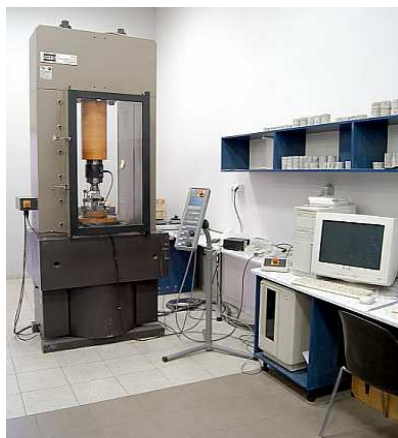
Rys. 3.1. Maszyna wytrzymałościowa MTS-815 Rock and Concrete Mechanics Testing System wraz komorą ciśnieniową do badań trójosiowych firmy MTS typu 656.11
