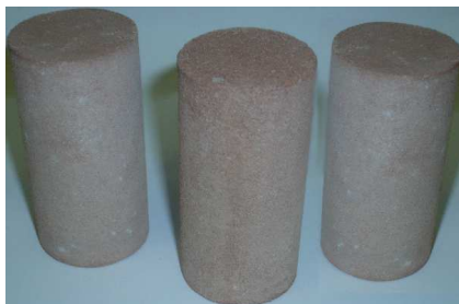
a) próbki walcowe, h=70 mm d=35 mm
