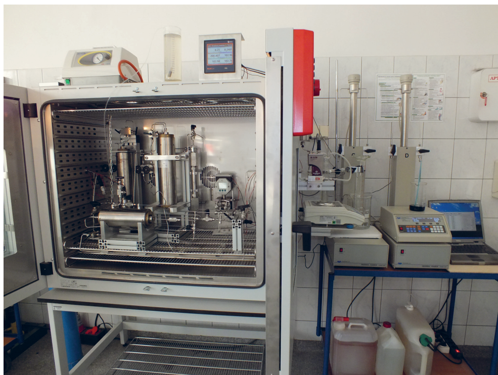
Rys. 5.12. Stanowisko badawcze – układ pomiarowy na wyjściu z rdzenia (fot. autor)
