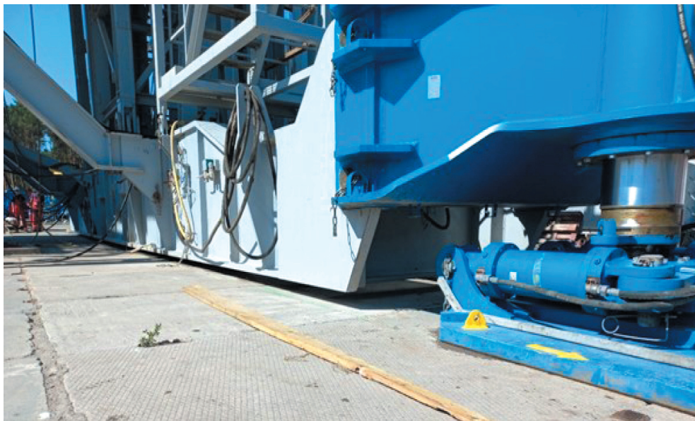
Rys. 1. Element systemu kroczącego Bentec połączony z podbudową urządzenia wiertniczego
