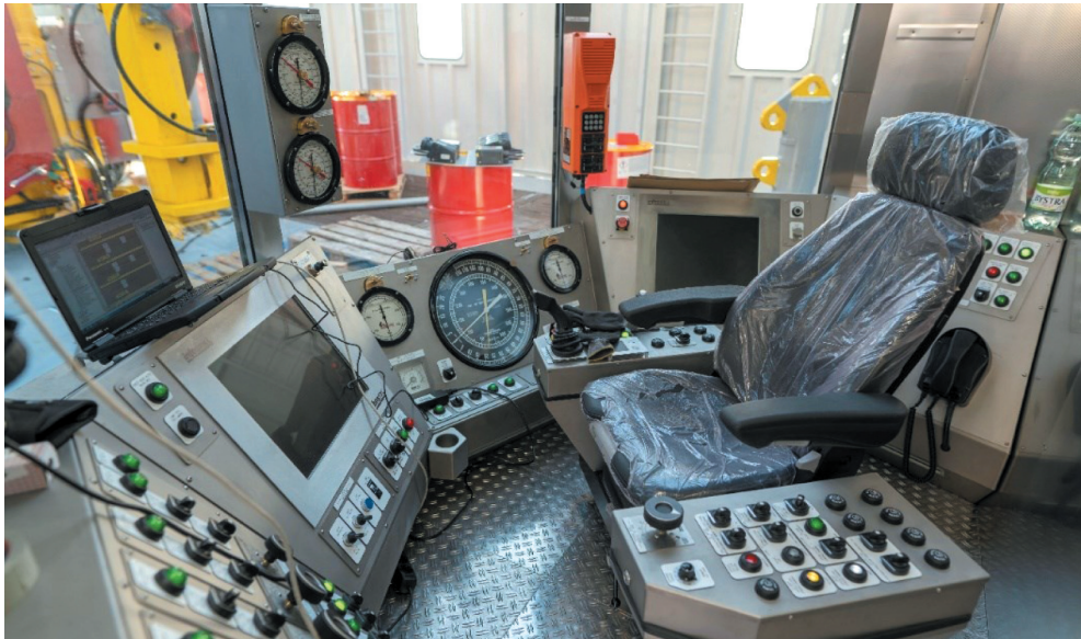
Rys. 2. Kajuta wiertacza – centrum sterowania urządzeniem wiertniczym Bentec 2000 HP
