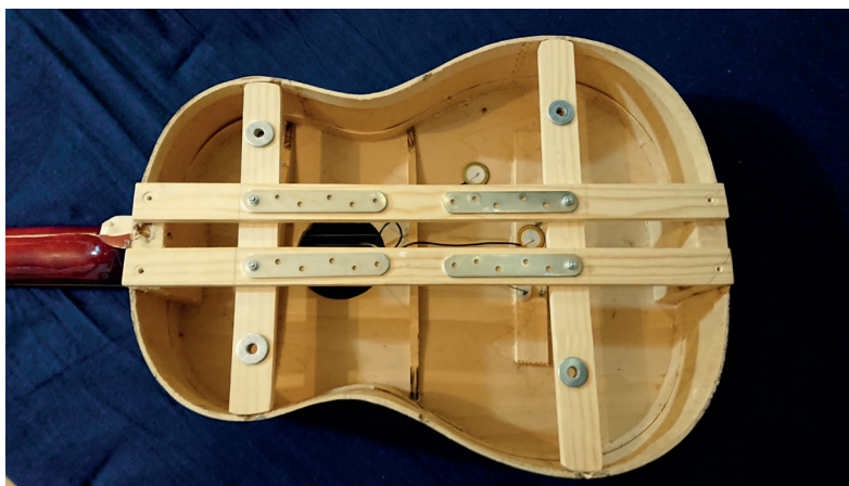
Rys. 2. Zdjęcie drewnianego szkieletu wprowadzonego w miejsce usuniętej płyty tylnej
