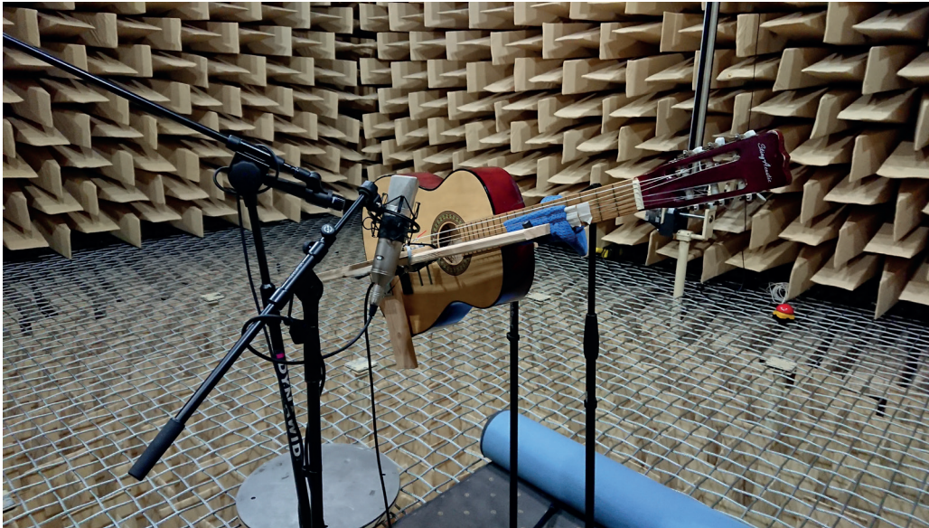
Rys. 5. Zdjęcie konfiguracji stanowiska badawczego do pomiarów zależności brzmienia chordofonu szarpanego od głębokości pudła rezonansowego
