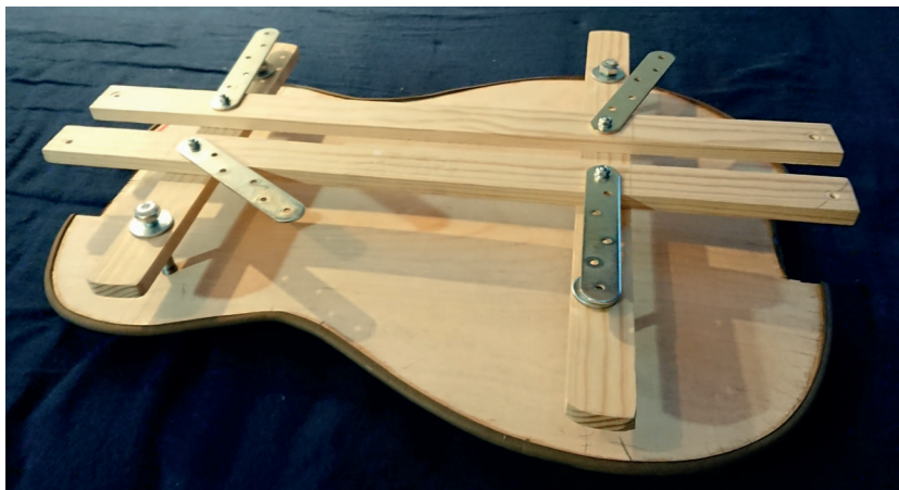
Rys. 3. Zdjęcie wewnętrznej płyty instrumentu zamontowanej do szkieletu konstrukcyjnego
