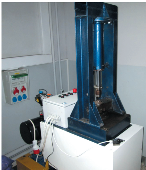
Rys. 6.4. Fotografia stanowiska laboratoryjnego do badania tarcia oraz zużycia w procesie brykietowania materiału drobnoziarnistego STZ-1M
