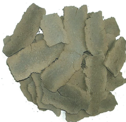
Rys. 4.12. Zdjęcie wyprasek otrzymanych w prasie walcowej z mieszanki komunalnych osadów ściekowych i odpadowego wapna palonego
