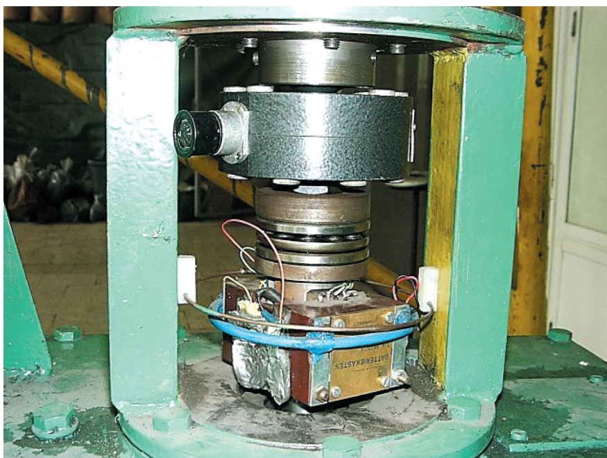
Rys. 5.5. Przystawka do pomiaru siły poosiowej i momentu skręcającego na wale ślimaka
