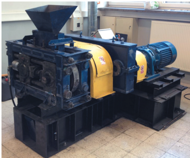
Rys. 4.11. Zdjęcie laboratoryjnej prasy walcowej LPW 450 wyposażonej w zasilacz grawitacyjny i gładkie walce
