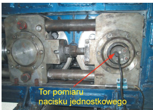
Rys. 4.10. Widok klatki walców roboczych laboratoryjnej prasy walcowej LPW 450 z zaznaczonym gniazdem pomiarowym nacisku jednostkowego we wgłębieniu formującym pierścienia oraz indukcyjnym czujnikiem przemieszczeń
