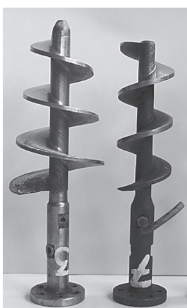
Rys. 5.3. Zdjęcie testowanych ślimaków: nr 3 (stożkowy) i nr 7 (walcowy)
