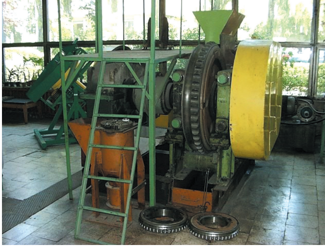
Rys. 4.40. Zdjęcie laboratoryjnej prasy walcowej LPW 1100 wyposażonej w zasilacz grawitacyjny i pierścienie formujące umożliwiające otrzymanie brykietów w kształcie siodła
