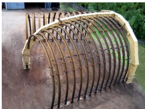
Rys. 2.5. Przykład obudowy portalowej skrzyżowania (PPG „Row-Jas”)
