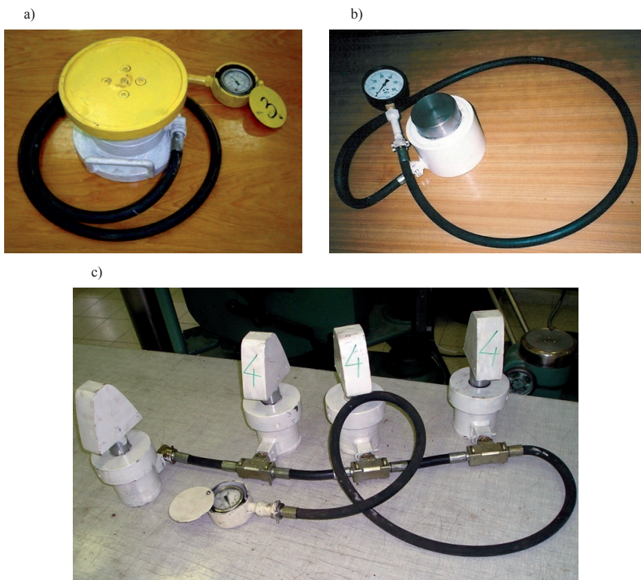
Rys. 4.24. Rodzaje dynamometrów stosowanych do pomiaru obciążeń obudowy: a) dynamometr stopowy, b) dynamometr stropowy pojedynczy, c) dynamometr szeregowy stropowy
