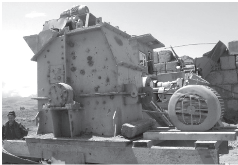
Rys. 6.67. Brak kosza zasypowego w kruszarce wimnikowej (Löwe 2010)
