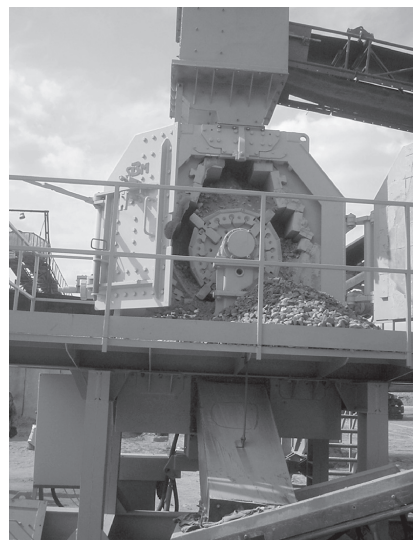
Rys. 6.70. Zablokowana kruszarka i rynna odprowadzająca produkt (Löwe 2010)
