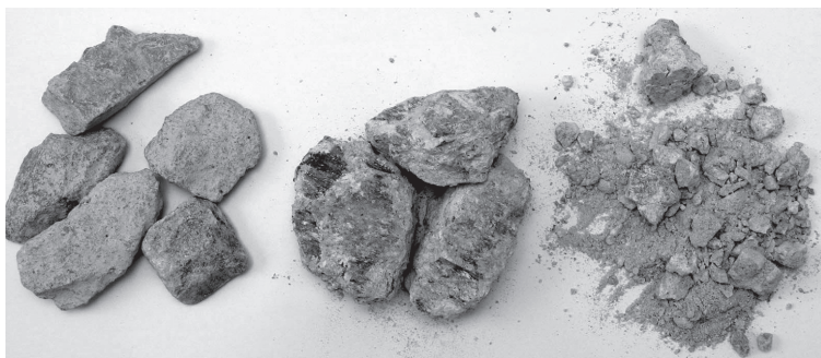
Rys. 4.16. Chińska ruda złota przed rozdrobnieniem (z lewej), po rozdrobnieniu w HPGR (w środku), po ściśnięciu płatków w dłoni (z prawej) (fot. T. Gawenda)
