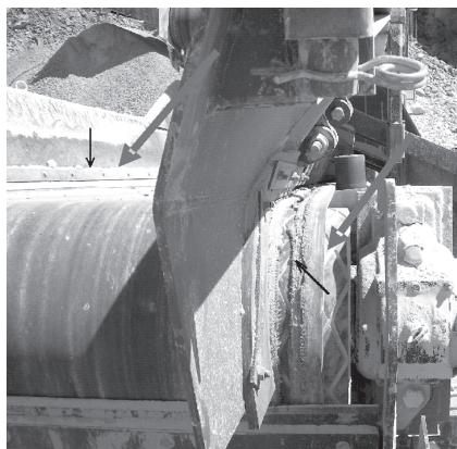
Rys. 6.73. Efekt wycierania się taśmy oraz sposób montażu bocznego gumowego fartucha i listwy uszczelniającej (fot. T. Gawenda)
