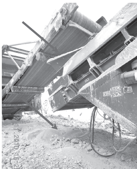
Rys. 6.71. Gromadzenie się drobnego kruszywa w miejscu przesypu z taśmociągu kruszarki do kosza zasypowego przesiewacza (fot. T. Gawenda)
