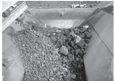
Rys. 6.68. Boczne (nierównomierne) zasilanie kosza zasypowego (Löwe 2010)
