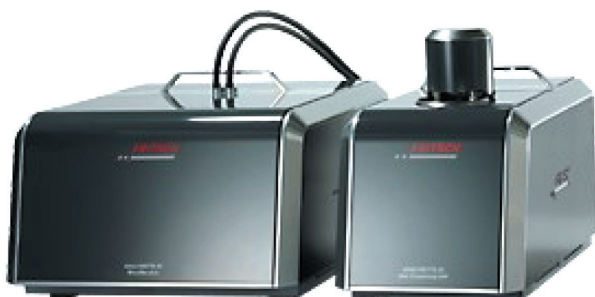
Rys. 3.3. Dyfrakcyjny analizator cząstek Analysette 22 MicroTec (źródło: www.fritsch-international.com )
