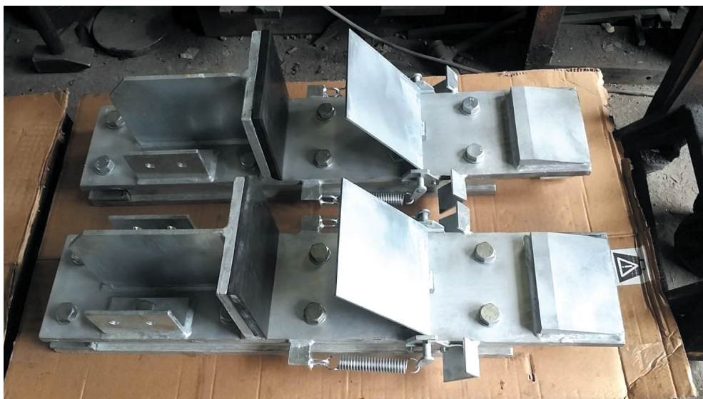
Rys. 11. Hamulce cierne z osłonami do zainstalowania w rzapiu
