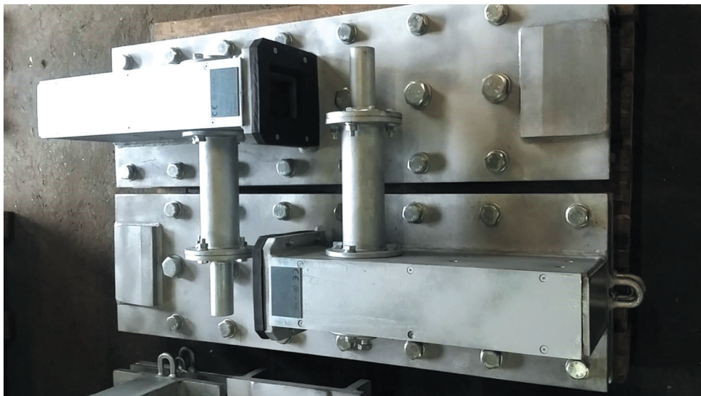
Rys. 10. Hamulce cierne z wychwytyami do zainstalowania w wieży szybu
