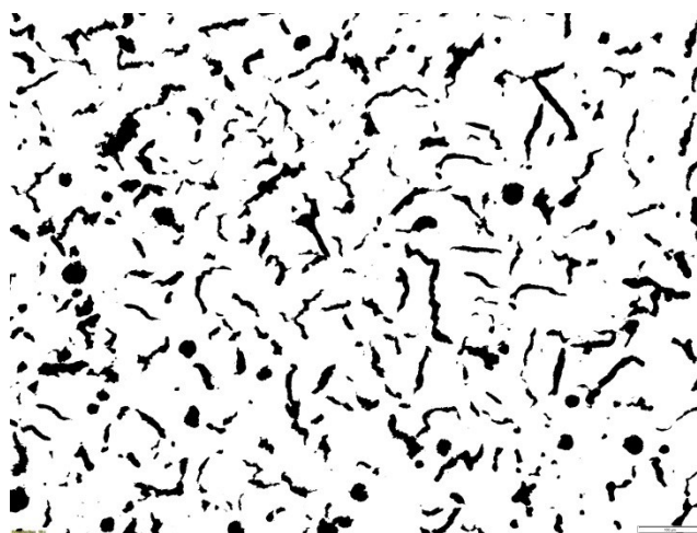
Rys. 2.49. Wydzielenia grafitu dla ścianki o grubości 6 mm zgląd nietrawiony, pow. 100x
