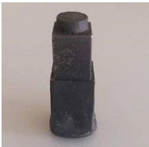
Rys. 1.20. Widok odlanej próbki do badań ultradźwiękowych
