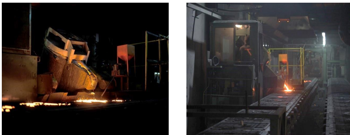
Rys. 2.11. Zalewanie form z żeliwa sferoidalnego na linii BMD
