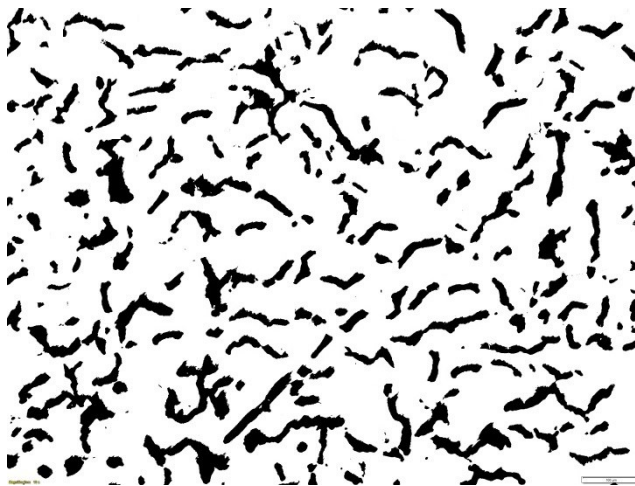
Rys. 2.55. Wydzielenia grafitu dla ścianki o grubości 34 mm zgląd nietrawiony, pow. 100x
