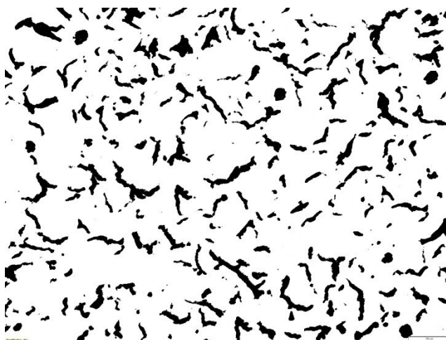
Rys. 2.53. Wydzielenia grafitu dla ścianki o grubości 22 mm zgląd nietrawiony, pow. 100x
