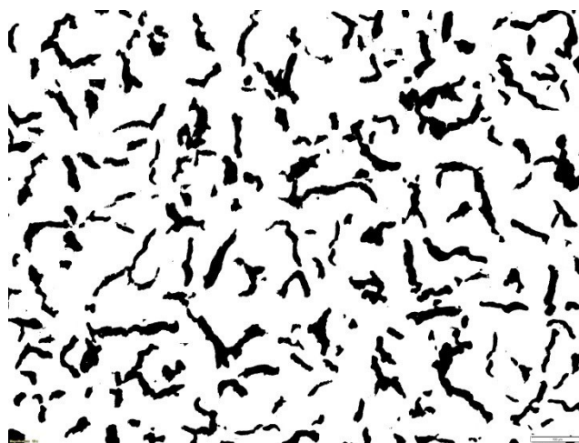
Rys. 2.67. Wydzielenia grafitu dla ścianki o grubości 46 mm zgląd nietrawiony, pow. 100x
