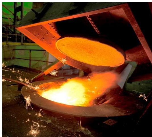
Rys. 2.4. Wytop żeliwa wyjściowego w piecu indukcyjnym
