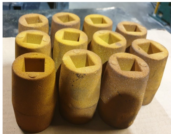
Rys. 2.9. a) rdzennica, b) wyprodukowane foremki do badań ultradźwiękowych
