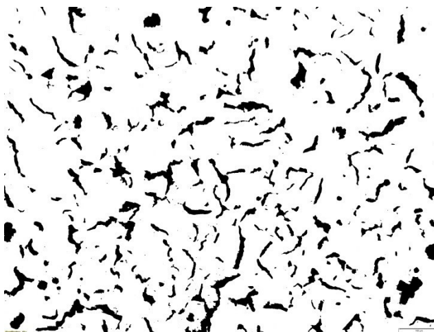
Rys. 2.63. Wydzielenia grafitu dla ścianki o grubości 22 mm zgląd nietrawiony, pow. 100x
