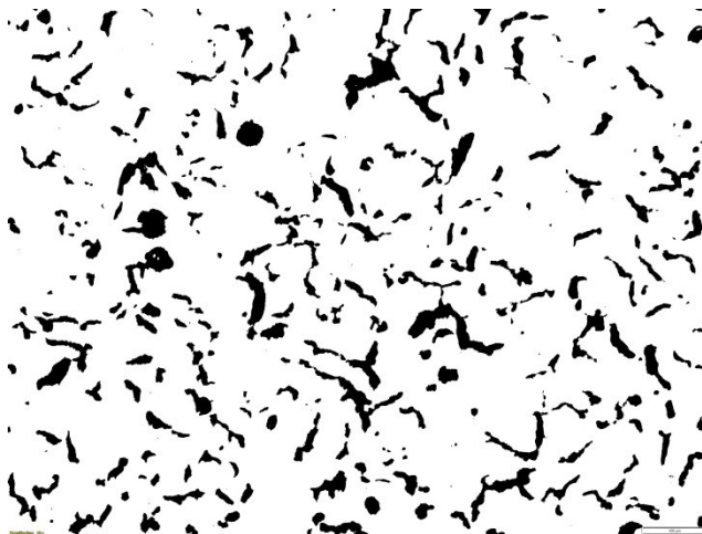
Rys. 2.51. Wydzielenia grafitu dla ścianki o grubości 12 mm zgląd nietrawiony, pow. 100x
