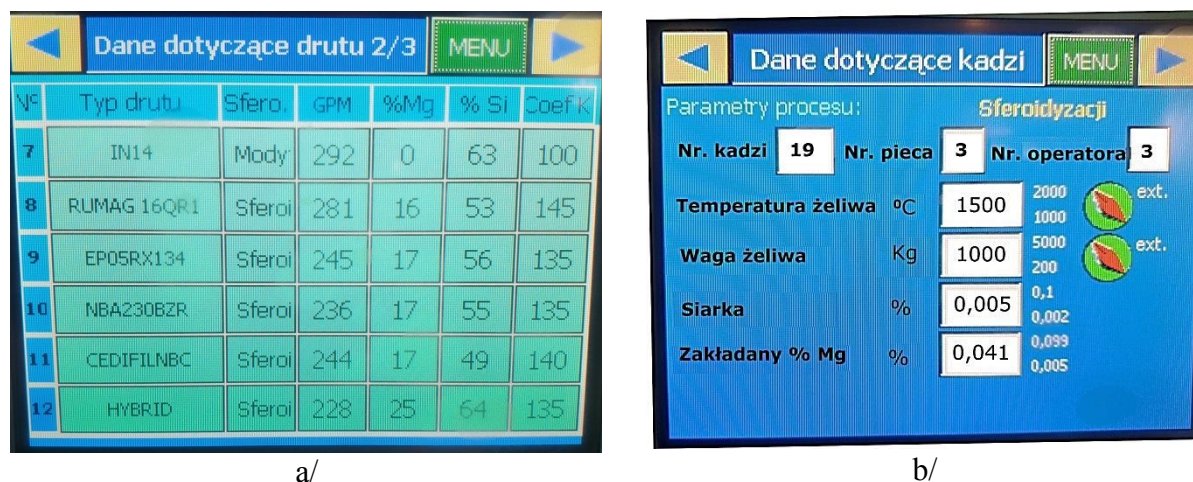
Rys. 2. 5. Parametry: a) pręta hybrydowego, b) uzyskane z wytopu żeliwa wyjściowego – wprowadzane do komputera podczas procesu sferoidyzacji
