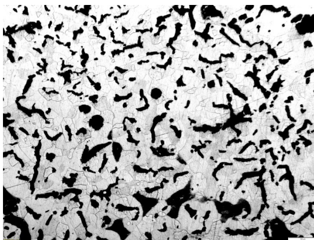
Rys. 2.64. Mikrostruktura żeliwa dla ścianki o grubości 22 mm zgląd trawiony, pow. 100x
