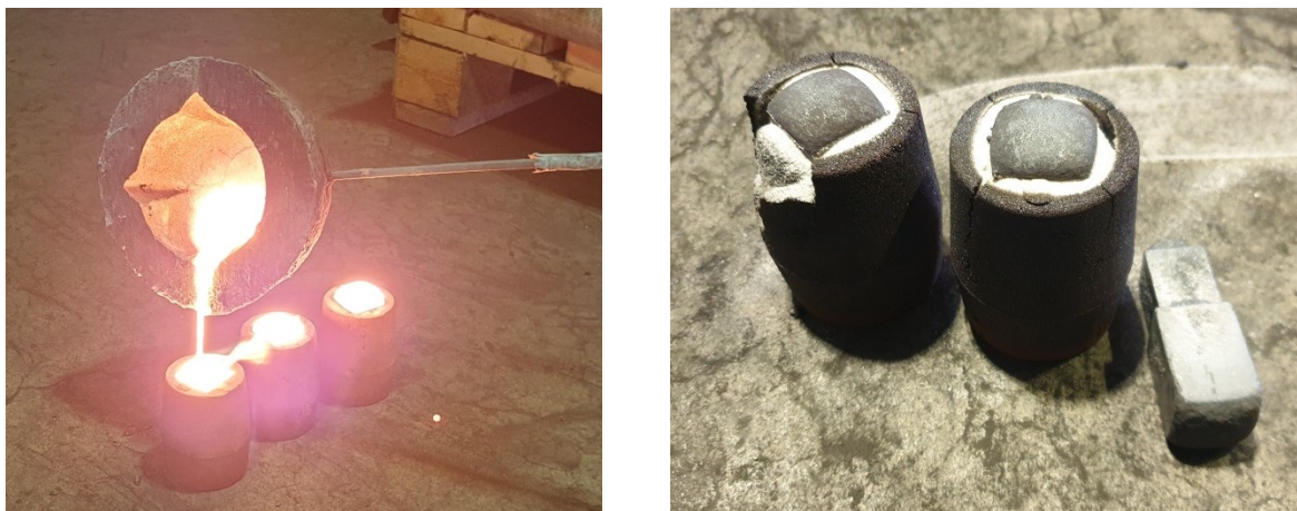
Rys. 2.12. Zalewanie próbek do badań ultradźwiękowych
