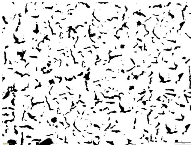
Rys. 2.59. Wydzielenia grafitu dla ścianki o grubości 6 mm zgląd nietrawiony, pow. 100x
