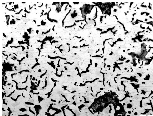
Rys. 2.56. Mikrostruktura żeliwa dla ścianki o grubości 34 mm zgląd trawiony, pow. 100x
