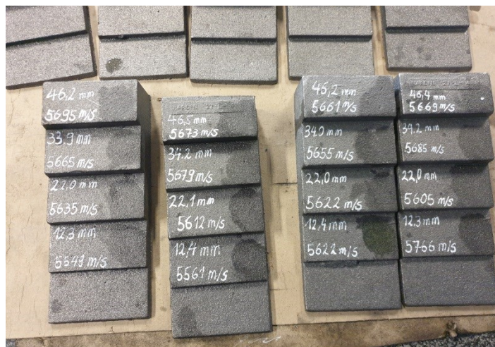
Rys. 2.24. Pomiar próbki schodkowej metodą ultradźwiękową
