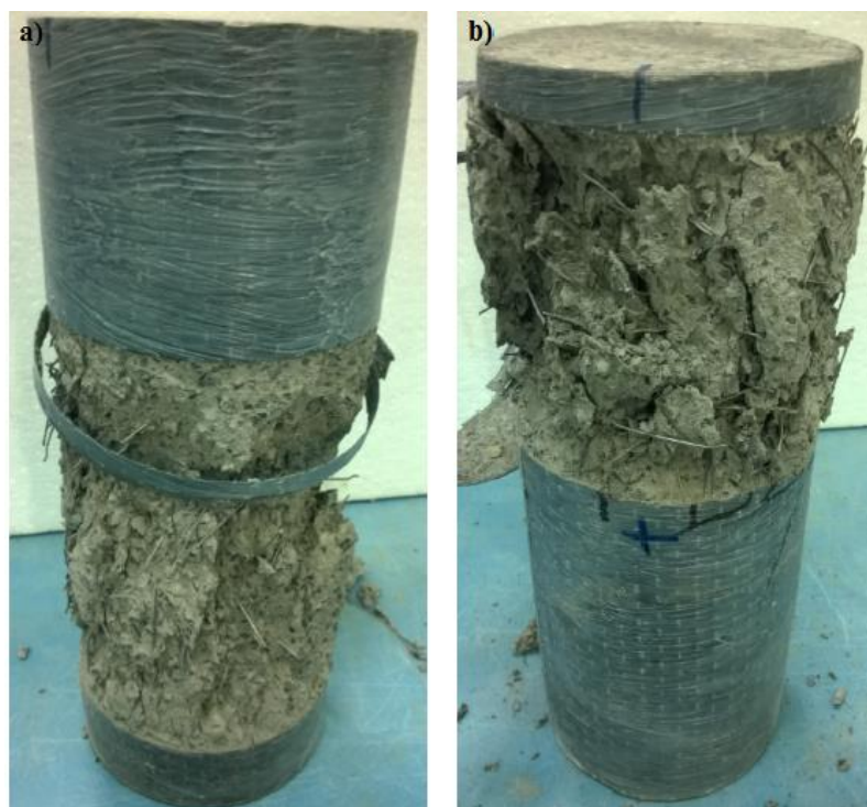
Rysunek 22. Zniszczenie kolumn z fibrobetonu zwykłego wzmocnionych CFRP.
