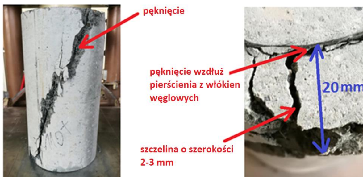
Rysunek 42. Reprezentatywny przebieg zniszczenia betonu HPSCFRC zawierającego zbrojenie w postaci CFRr (próbka C110-3).
