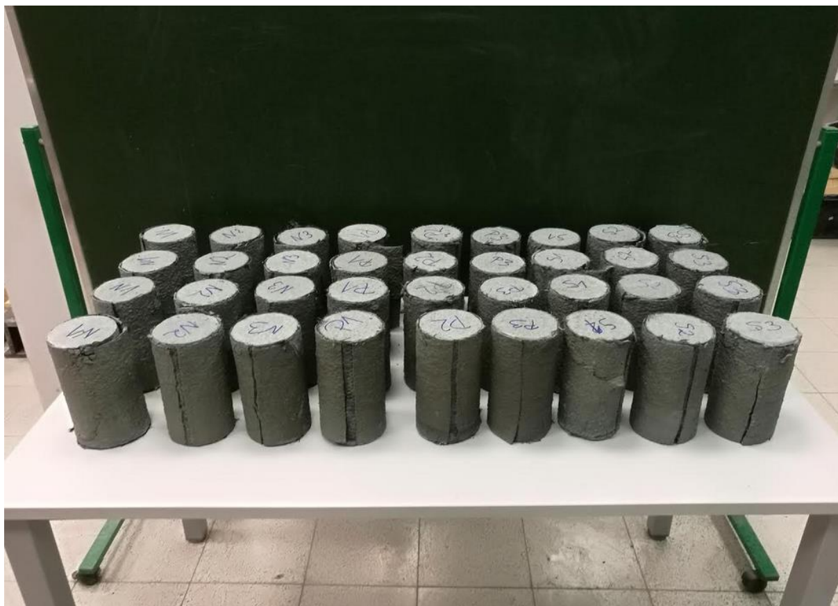
Rysunek 64. Próbki betonowe wzmocnione włóknami węglowymi przy użyciu matrycy cementowej po zniszczeniu.
