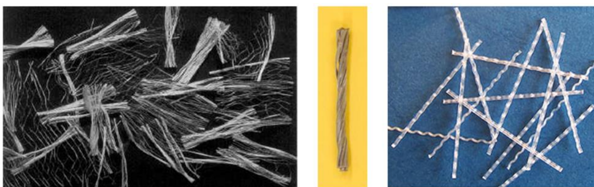
Rysunek 12. Przykłady kształtu włókien stalowych przeznaczonych do betonu: z haczykowatymi odgięciami na obu końcach (1), klejone w pasma (2), z zakotwieniami uformowanymi na końcach (3,7), o kształcie wiosłowym (4), faliste (5,6), proste gładkie (8).
