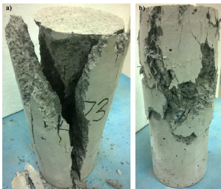
Rysunek 20. Zniszczenie kolumn z betonu zwykłego (a) i fibrobetonu zwykłego (b).
