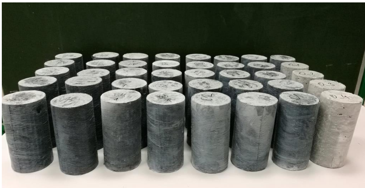
Rysunek 55. Próbki betonowe wzmocnione włóknami węglowymi przy użyciu żywicy epoksydowej oraz próbki świadki.
