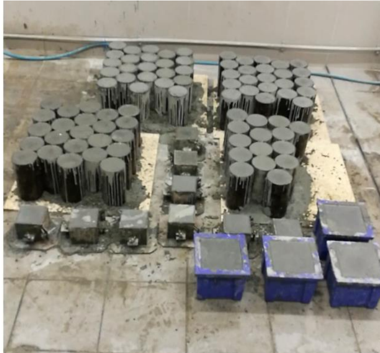
Rysunek 45. Formy po zabetonowaniu mieszanką betonową.
