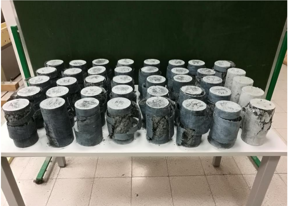
Rysunek 60. Próbki betonowe wzmocnione włóknami węglowymi przy użyciu żywicy epoksydowej po zniszczeniu.
