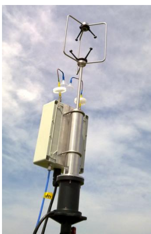
Rys. 5.11. Instalacja na szczycie masztu: trójwymiarowy wiatromierz ultradźwiękowy Gill Windmaster Pro (a), czepnie powietrza (b), filtry cząstek stałych (c) oraz szybkozmiennne zawory rozdzielające próbki powietrza (d), zamknięte w obudowie chroniącej przed warunkami atmosferycznymi. Kolorem niebieskim zaznaczono drogę pobieranego powietrza, czerwonym połączenie z jednostką sterującą zaworami. Odległość pomiędzy środkiem geometrycznym wiatromierza a punktem poboru próbek wynosi około 25cm. [Gill Instruments Ltd., zmodyfikowano]. Zdjęcie przedstawia rzeczywisty wygląd instalacji.
