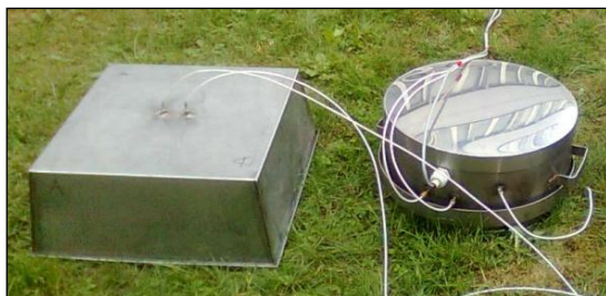
Rys. 4.1. Konstrukcje komór pomiarowych wykorzystanych do badania strumienia \text{CO}_2 z gleby w Krakowie.
