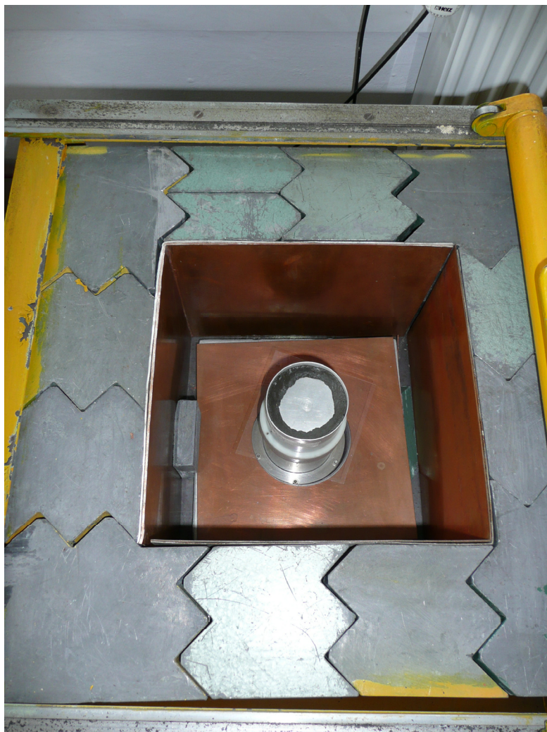
Rys.24. Detektor HPGe – górna osłona otwarta (ze zbiorów autorki)
