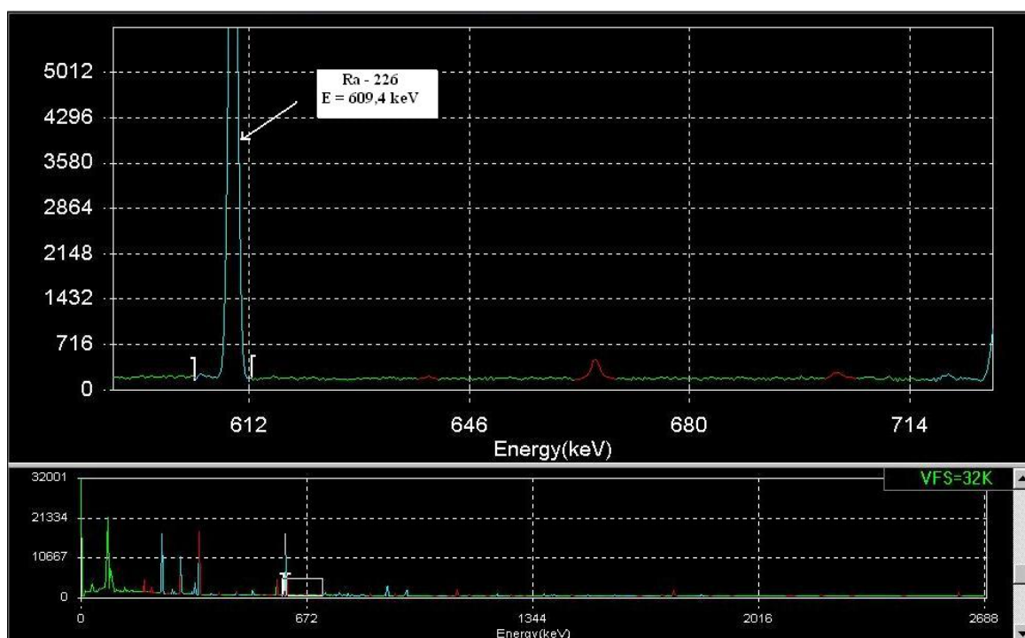
Rys.25. Przykładowe widmo promieniowania gamma próbki osadu wraz z pikiem 609,4 keV pochodzącym od bizmutu ^{214}\text{Bi} .
