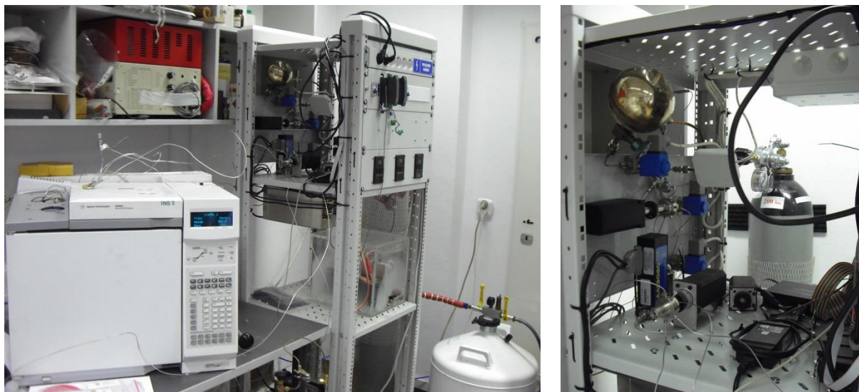
Rys. 4.8. Widok ogólny układu pomiarowego do analiz stężenia gazów śladowych w próbkach gazowych.
