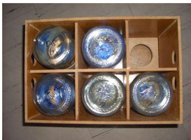
Rys. 4.5. Sposób przechowywania prób gazów uzyskanych w procesie ekstrakcji dynamicznej.
