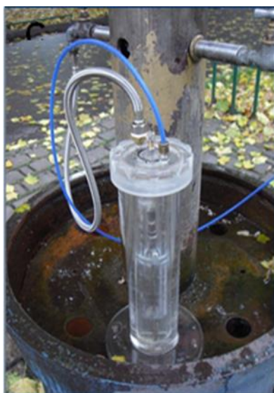
Rys. 4.3. Syfon do ekstrakcji gazów rozpuszczonych w wodzie w trakcie pracy
