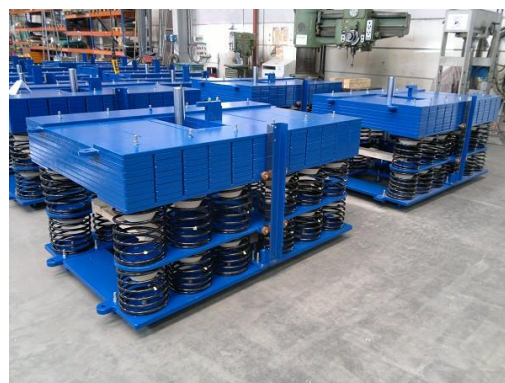
Rys. 3.10. Widok układów MR-STMD (Weber i Maślanka 2012)
