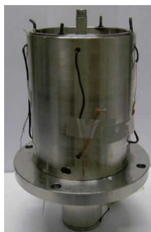
Rys. 1.5. Tłumik MR ze zintegrowanym przetwornikiem drgań: a) budowa, b) widok (Chen i Liao 2010)
