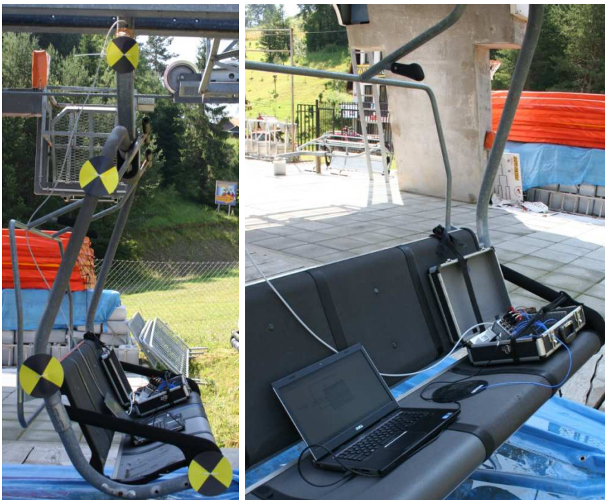
Rys.VII.4. Krzesło pomiarowe z zamontowanym układem mierzaco-rejestrującym (lipiec 2012).
