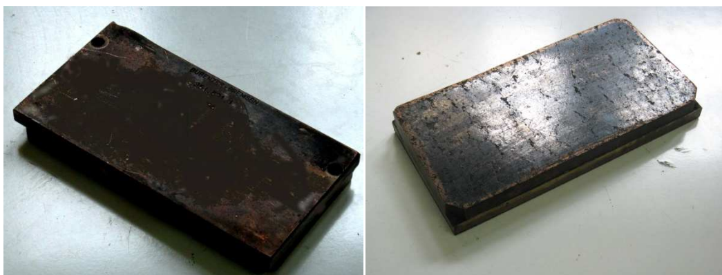
Rys.VI.6. Szczęka zespołu hamulca ruchowego użyta podczas badań na stanowisku laboratoryjnym.
