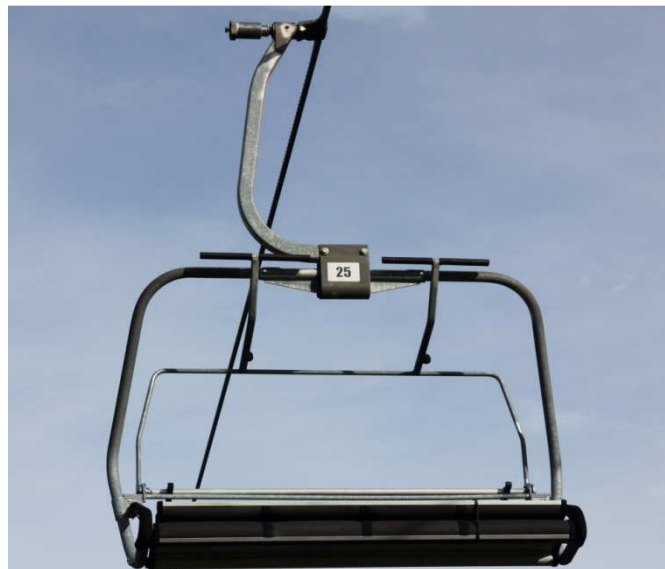
Rys. IV.7. Pojazd kolei linowej „Słotwiny” – krzesło 4-osobowe.
