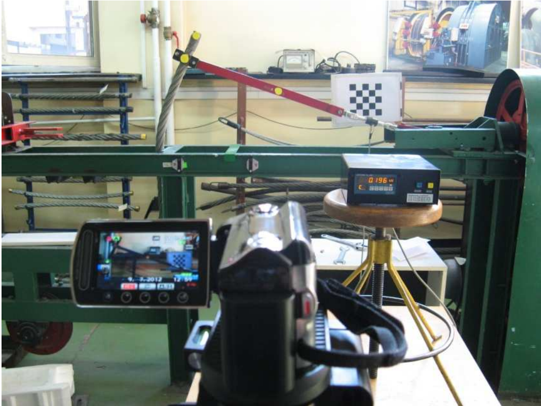
Rys.VI.2. Próba zginania jednostronnie zamocowanego cięga z wykorzystaniem metody wizyjnej.
