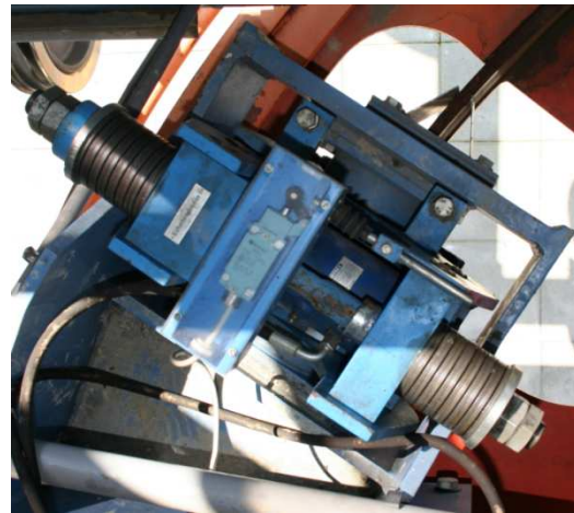
Rys. II.2. Hamulec główny (schemat wg [108]) zamontowany na kole napędowym kolei.
