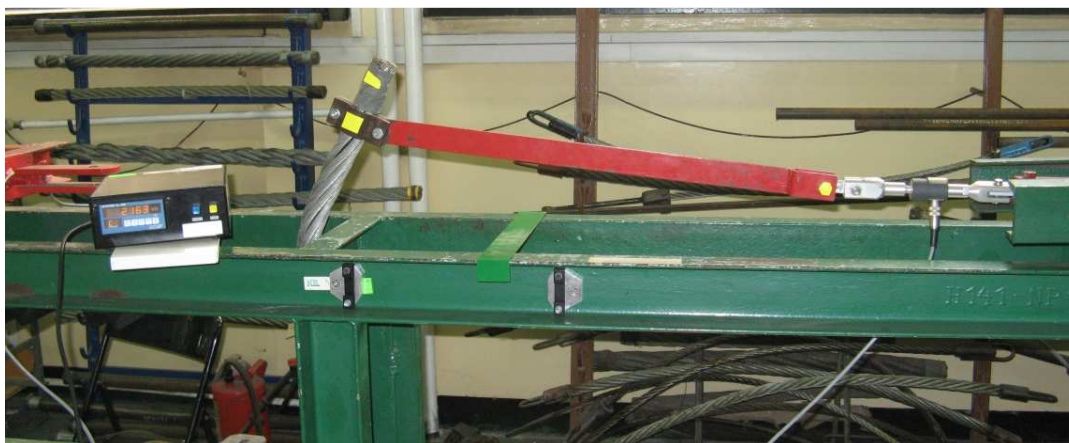
Rys.VI.1. Próba zginania jednostronnie zamocowanego cięgna.
