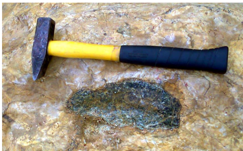
Fig. 5.8.1. Gniazdowe skupienie skały chlorytowej w marmurze złocistym.
