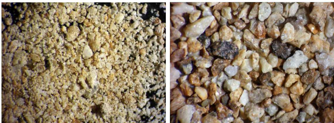
Fig. 5.9.12. Marmur złocisty kruszony o frakcji 0 – 1,5 mm. Po lewej: Drobne okruchy marmuru złocistego. Powiększenie 40x. Po prawej: Najgrubsze ziarna wydzielone z badanej frakcji z widocznym sporym udziałem okruchów marmuru białego i szarego. Powiększenie 80x.
