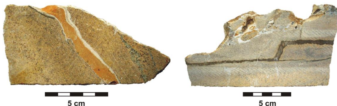
Fig. 5.4.7. Przykładowa mineralizacja żyłowa w marmurze złocistym.
