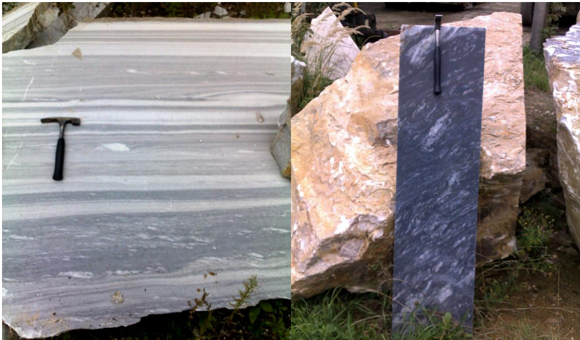
Fig. 5.3.1. Przykładowe szaroniebieskie marmury sławniowickie, warstwowane, w odcieniu jasnoszarym (po lewej) oraz ciemnoszarym (po prawej)
