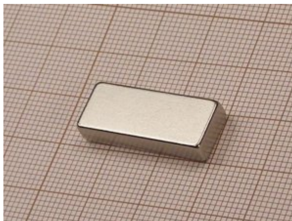
Rys. 5.11. Magnes neodymowy typu MPŁ 25 x 10 x 5 / N38, wykorzystany w badaniach eksperymentalnych
