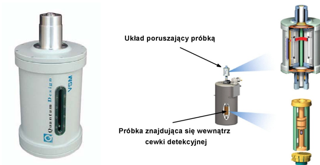
Rys. 3.14. Układ pomiarowy PPMS z przekrojami ilustrującymi szczegóły opcji VSM [152]
