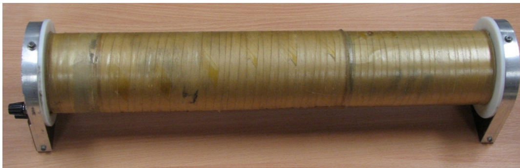
Rys. 5.4. Zdjęcia solenoidu użytego do stymulacji ziarniaków polem magnetycznym
