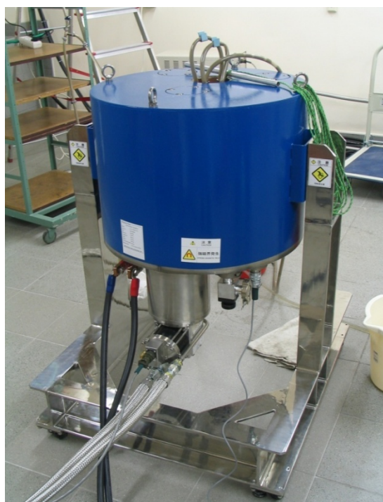
Rys. 5.8. Widok elektromagnesu nadprzewodnikowego model HF10-100VHT-B, będącego źródłem pola magnetycznego
