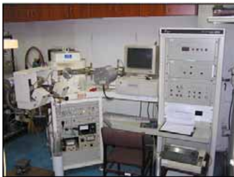
Rys. 5.7. Spektrometr mas MAT 251 stosowany w niniejszej pracy do pomiaru \delta^{15}N i \delta^{18}O w azotanach.
