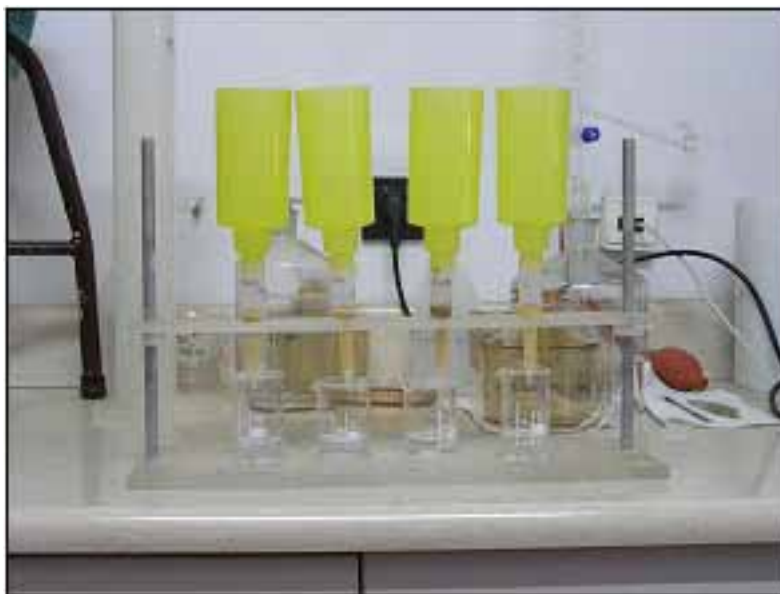
Rys. 5.3. Statyw ekstrakcyjny z czterema kolumnami. Azotany wymywane są przez 3–molowy roztwór kwasu solnego.
