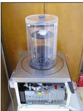
Rys. 5.4. Liofilizator CHRIST LOC-2M z umieszczonym w środku naczyniem zawierającym zamrożony roztwór z azotanami.
