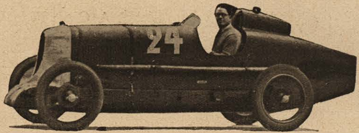
Samochód angielskiego rekordzisty Eldridge'a z karoserją zaopatrzoną w grzbiet, zabezpieczający głowę kierowcy w razie katastrofy.
