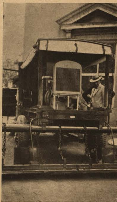
Widok z tyłu elektromagnetycznej zbieraczki żelaza.
