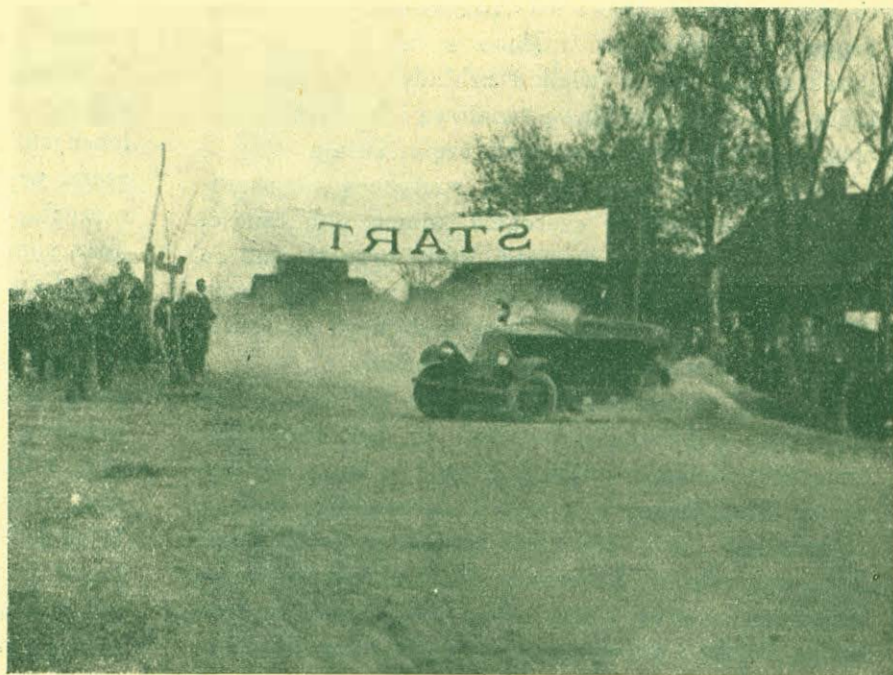
Senacyjna próba wytrzymałości pneumatyków Michelin urządzona była w Strudze pod Warszawą. Samochód, jadący pełnym gazem na nienapompowanej oponie, zawrócił nagle o 180°, przyczem pneumatyk nie spadł z obręczy.
