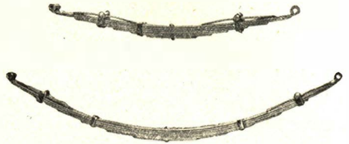
Resory z widocznymi płytkami amortyzacyjnymi.
