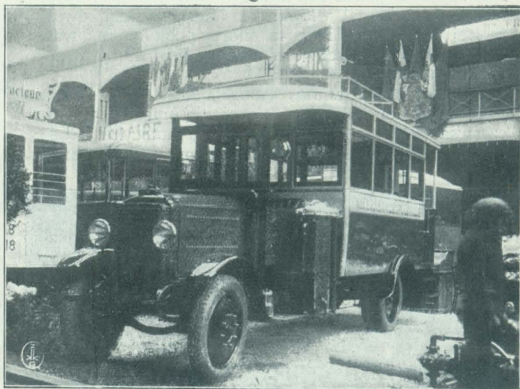
Z Salonu Brukselskiego. Autobus z gazogeneratorem „Pipe”.
