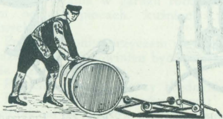
Rys. 276. Podnośnik beczek w położeniu do przyjęcia lub stoczenia beczki na ziemię.
