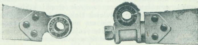
Rys. 236. Dwa modele Silentbloca zastosowane do amortyzatorów Hartford.
