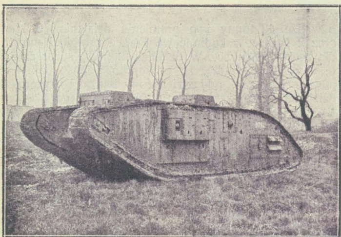
Rys. 284. Czołg angielski Mark V. Star Tank, mogący, prócz załogi, pomieścić w tylnej części 20 piechurów.
