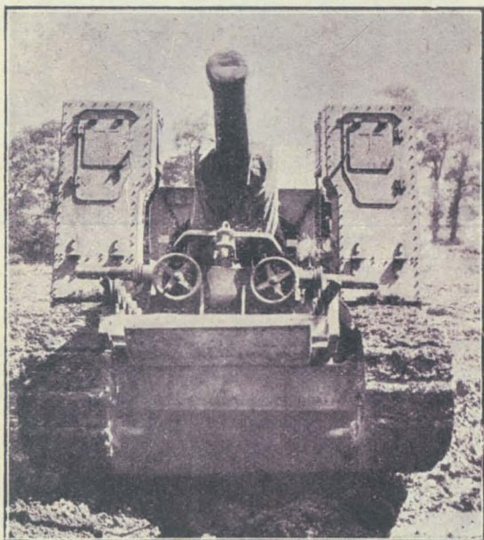
Rys. 286. Czołg angielski „Gun-Carrier Tank“ jako holownik działa 125 mm. lub 150 mm. wraz z 64 pociskami.
