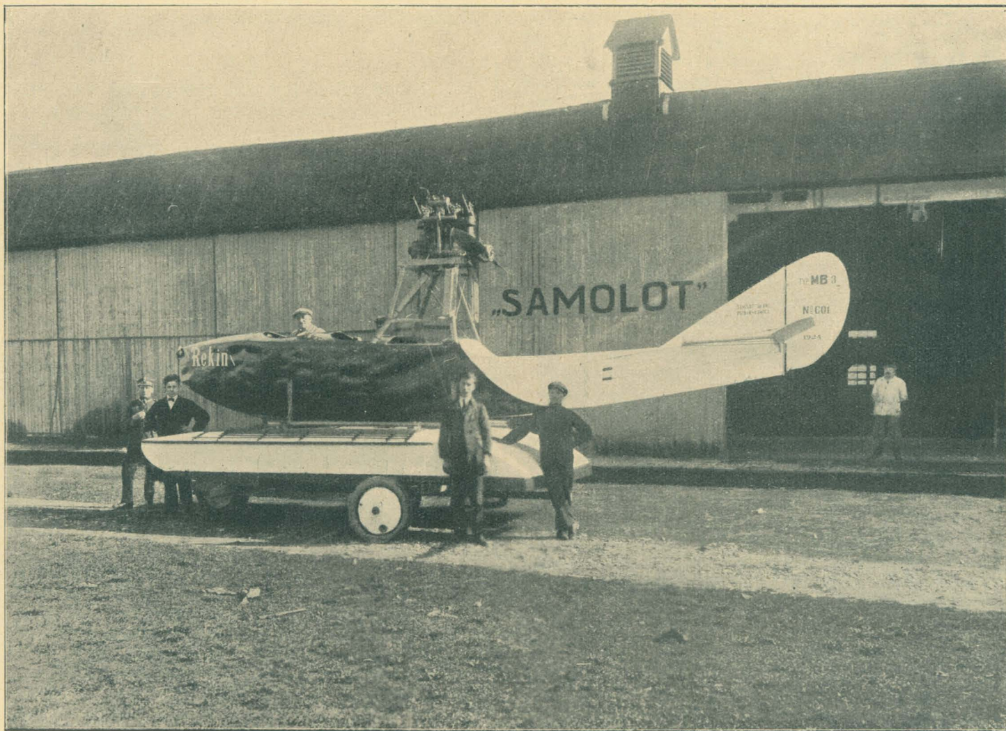
Rys. 97. Ślizowiec polski inż. M. Bogatyrewa. (Długość 4.50 m., szerokość 1 m. 20, waga 500 kg. Silnik 80 km. „Argus“. Nośność 4 osoby. Zanurzenie 5 cmt.).
