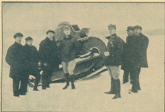
Rys. 123. Kapitan wojsk samochod. Grossman i por. 1 pułku czołgów Kuszelewski podczas prób czołga „Renault” na gąsienicy kpt. Kardaszewicza w zimie 1923—1924 r. Zdjęcia dokonano w okolicy Sulejówka po przejechaniu 329 klm. na nowej gąsienicy.
