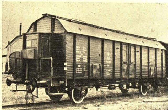
Rys. 8. Wagon serii Sd do przewożenia drobiu, zbudowany w wytwórni S. A. Wielkich Pieców i Zakładów Ostrowieckich.
