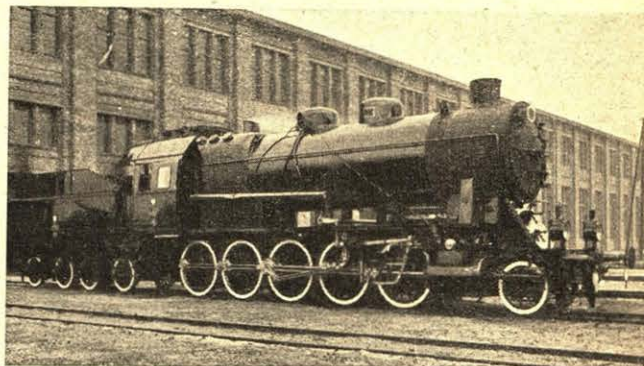
Rys. 2. Parowóz serii Ty 23 (1—5—0) zbudowany w wytwórni H. Cegielski.
