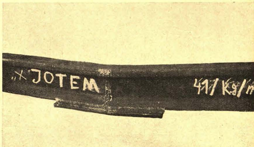
Fot. 2. Jedna z prób udanych. Spawane szyny typu 8-a.
