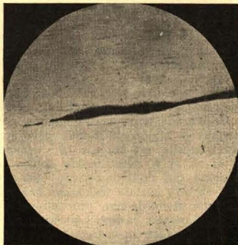
Rys. 18. Zdjęcie mikroskopowe nietrawione tworzywa ścianki Pow. 80 kr.
