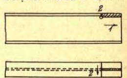
Obcięcie naroża belki
