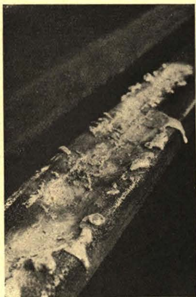
Rys. 13. Szyna po wypaleniu raka.
