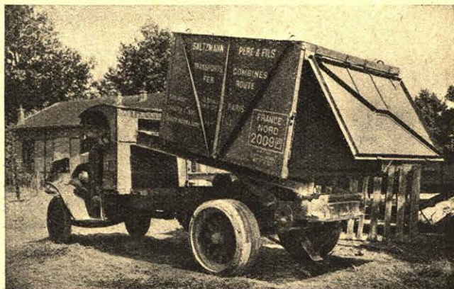
Rys. 35. Samochód przystosowany do przewozu kontenerów z cegłą, ustawiony do wyładowania.
