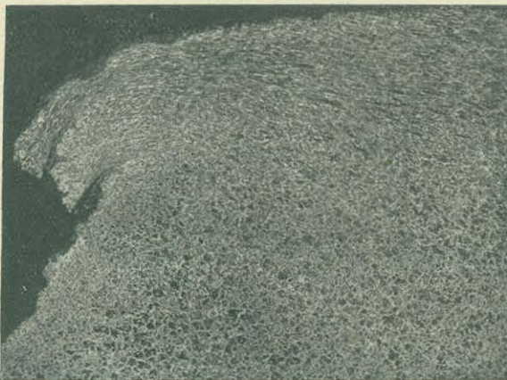
Fot. 1. Występ z boku główki wskutek rozwałcowania kołami pociągów
