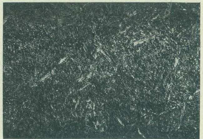
Rys. 6. Ulepszanie zastępcze doskonałe, struktura nierównomierna — sorbityczna.
