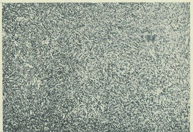
Rys. 5. Struktura sorbityczna, otrzymana przy termicznym ulepszeniu. (Szbk. hart. 50°/sek.)
