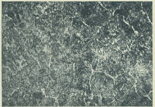
Rys. 4. Struktura perlito-sorbityczna, otrzymana przy termicznym ulepszeniu (szybkość hartowania 23°/sek.)
