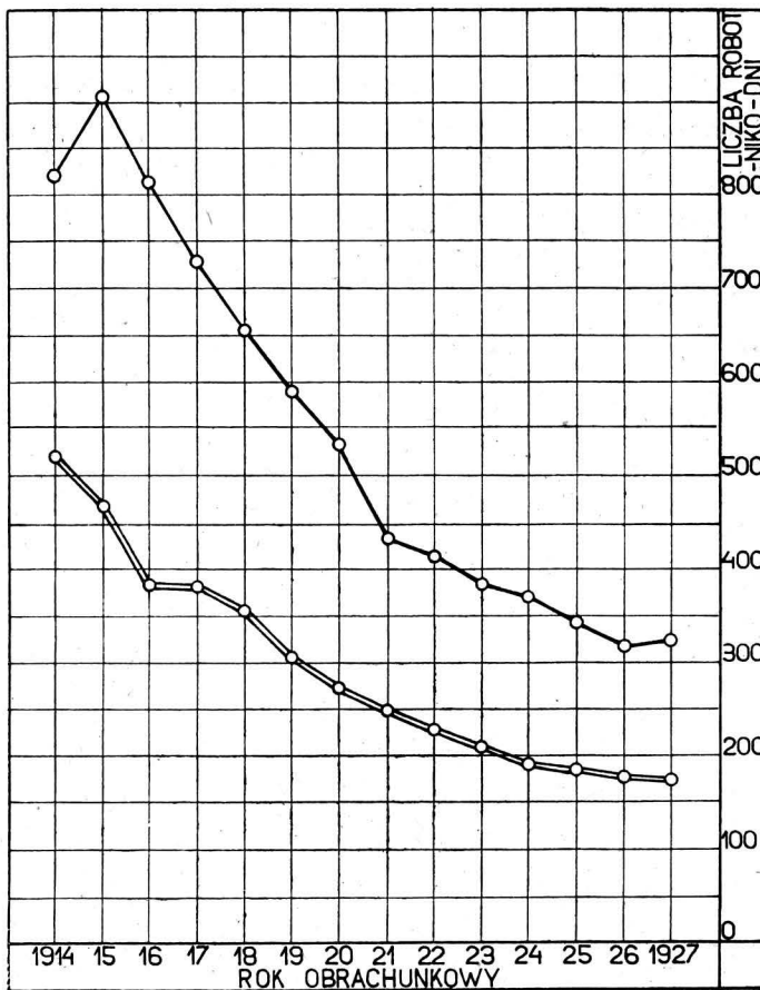
Fig. 3 a. Średnia liczba robotniko-dni potrzebnych dla naprawy jednego parowozu.
