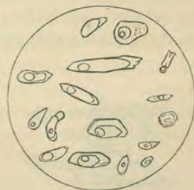
Fig. 4. Kropelki dwutlenku węgla w próżniach berylu.
