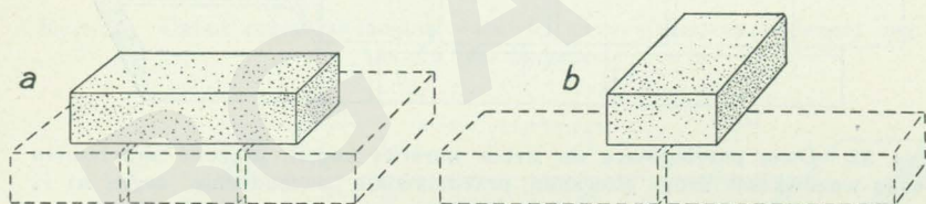
Rys. 49. Cegła, ułożona swoją długą stroną, jak wskazuje a, nazywa się wozówką, ułożona zaś krótszą stroną, jak wskazuje b — główką.
