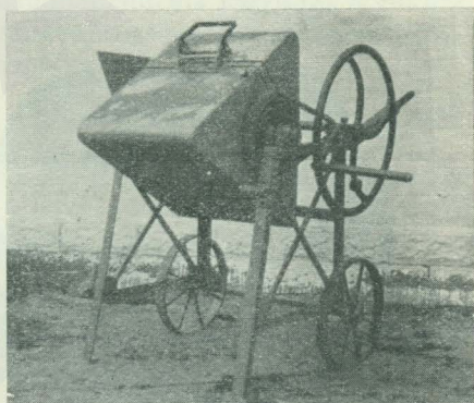
Fot. 7. Betoniarka z napędem ręcznym, wyrabiana w kraju. Mieszadło w formie trójścianu.
