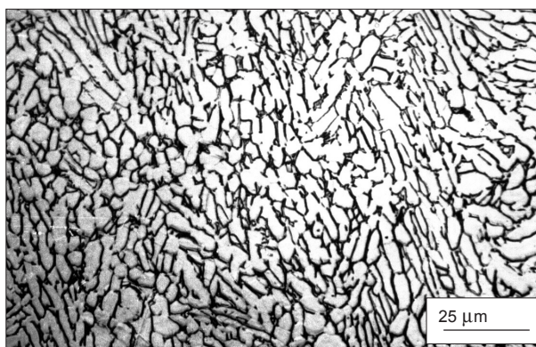
Rys. 4.86. Struktura materiału otrzymanego z proszku stopu tytanu Ti6Al4V po odkształceniu \epsilon = 30\% i wyżarzeniu w temperaturze 900^{\circ}\text{C} w czasie 0,5 h, obserwowana na mikroskopie optycznym [18, 19]
