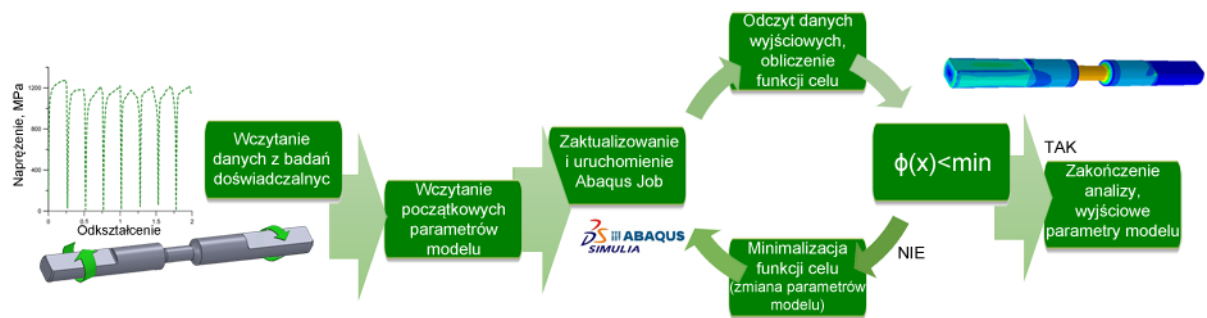
Rys. 9.1 Schemat działania zastosowanej metody odwrotnej.
