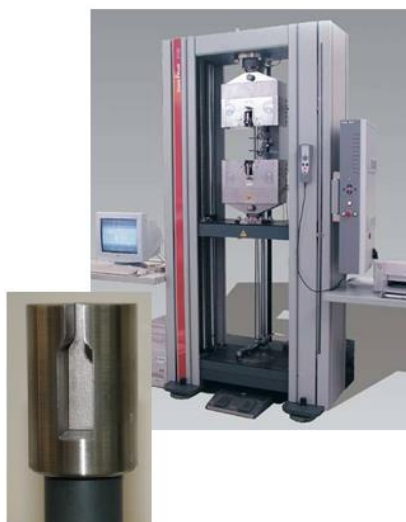
Rys. 7.2 Maszyna wytrzymałościowa Zwick Z250
