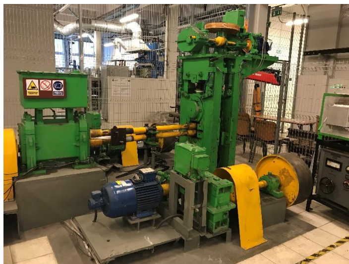
Rys. 7.4 Laboratoryjna walcarka kwarto.
