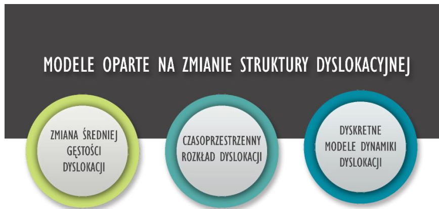
Rys. 5.7 Ogólny podział modeli naprężenia uplastyczniającego wykorzystujących gęstość dyslokacji do opisu zjawisk zachodzących w materiale.
