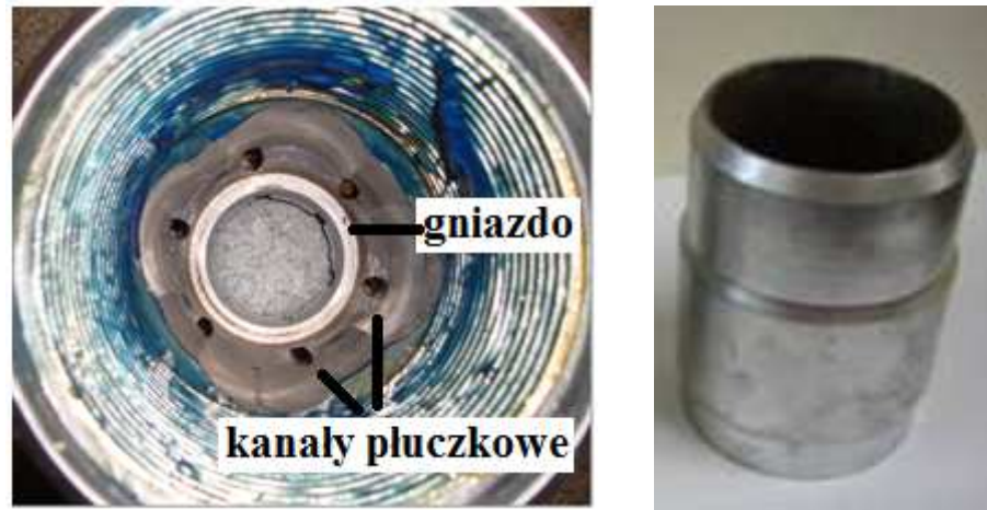
Rys. 2.13. Wnętrze koronki typu Low Invasion oraz kadłuby urywaka typu Lip Shoe. (fot. D Janc)
