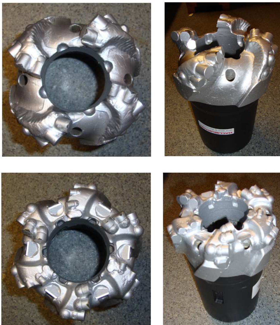
Rys.5.5. Koronka rdzeniowa 149 mm typu „Low Invasion” ze stalowym korpusem. (fot. D. Janc)
