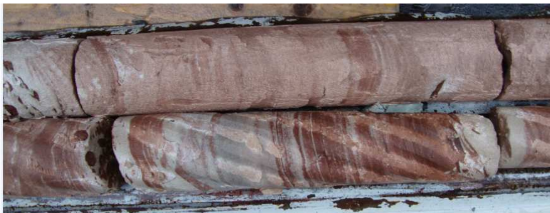
Rys. 5. 2. Zmniejszenie średnicy rdzenia 4” poprzez erozyjne działanie strumienia płuczki wiertniczej oraz zjawisko „whirlingu” – otwór W-III/4W. (fot. D. Janc)
