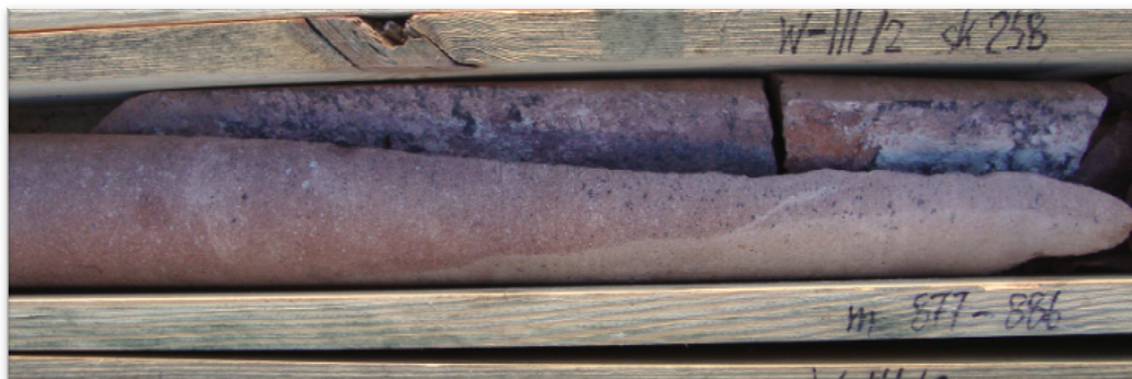
Rys.5.9. Spękania górotworu – otwór W-III/2. (fot. D. Janc)
