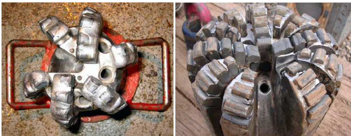
Rys. 2.40. Świder do mikrordzeniowania: PDC 6", diamentowy impregnowany 8 1/2". [8]
