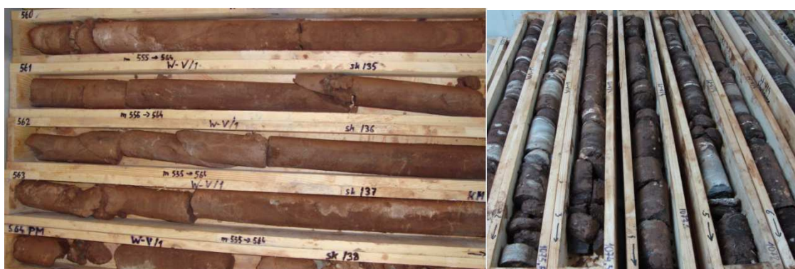
Rys. 3.4. Iłowce i iłolupki – cechsztyń górny – otwór W-V/1 i W-V/4. (fot. D. Janc)
