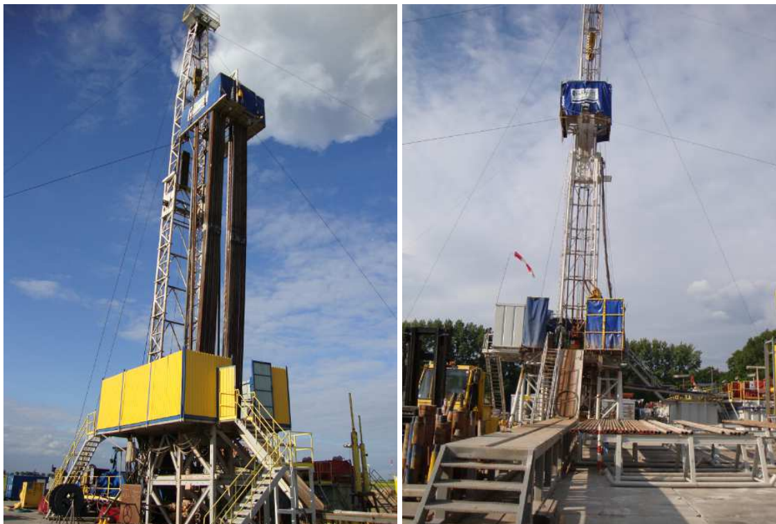
Rys. 4.2. Urządzenie wiertnicze P-80 (po lewej) i IRI-750 (po prawej). (fot. D. Janc)
