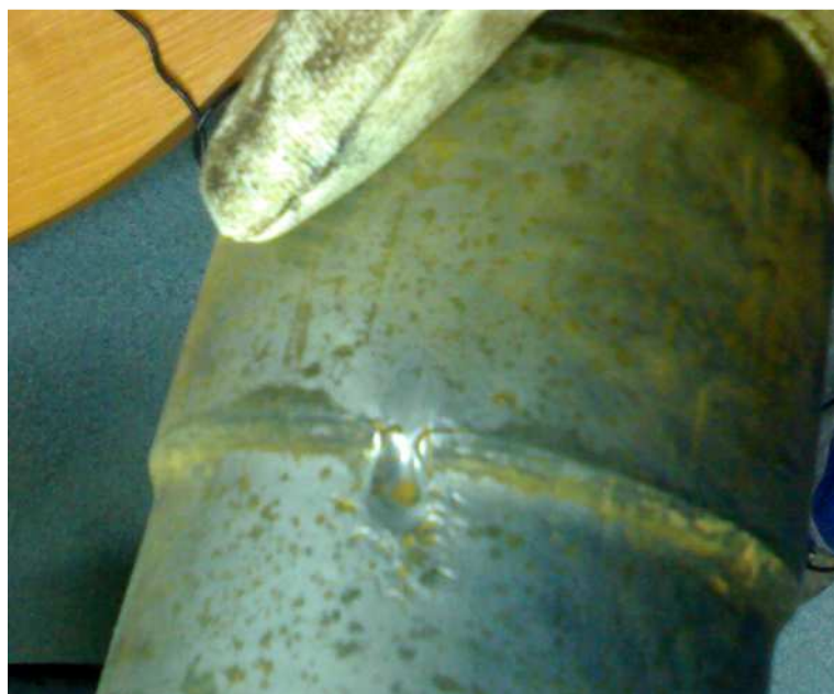
Rys. 5.4. Uszkodzony kadłub urywaka rdzenia i wyniku obracania się rury wewnętrznej wraz z rurą zewnętrzną. (fot. D. Janc)
