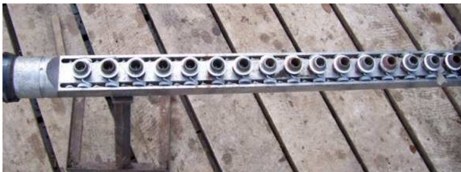
Rys. 2.36. Aparat rdzeniowy boczny udarowy (Weatherford). [45]
