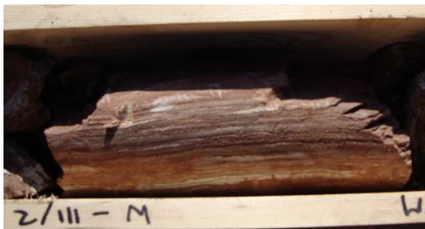
Rys 5.7. Łupki o pionowym kącie upadu – otwór W-III/2. (fot. D. Janc)
