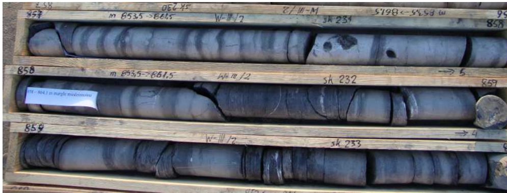
Rys. 3.6. Margle miedzionośne i ołowionośne – cechsztyń dolny – Otwór W-III/2. (Fot. D. Janc)
