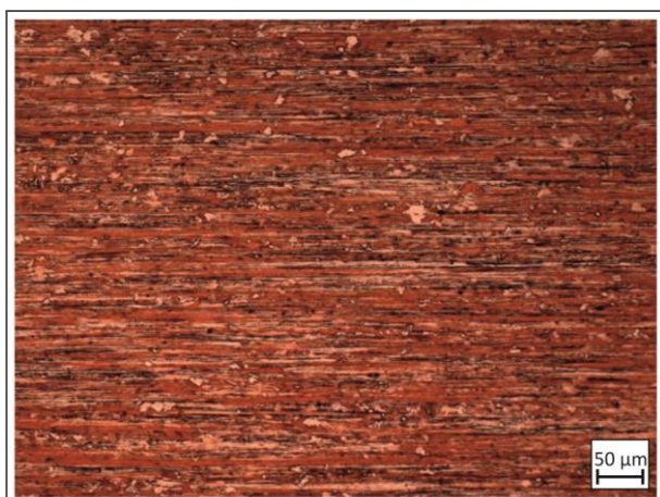
Rys. 9.3.15. Mikrostruktura przekroju wzdłużnego drutu o średnicy 2,5 mm z miedzi w gatunku Cu-ETP po procesie wygrzewania w temperaturze 160 °C w czasie 1 h
