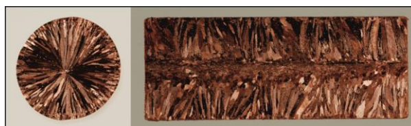
Rys. 9.1.11. Makrostruktura przekroju poprzecznego i wzdłużnego pręta z miedzi w gatunku Cu-OFE uzyskanego w procesie ciągłego odlewania w warunkach przemysłowych na instalacji Upcast przy prędkości odlewania 2,0 m/min. oraz przy przepływie wody chłodzącej krystalizator 40 l/min.
