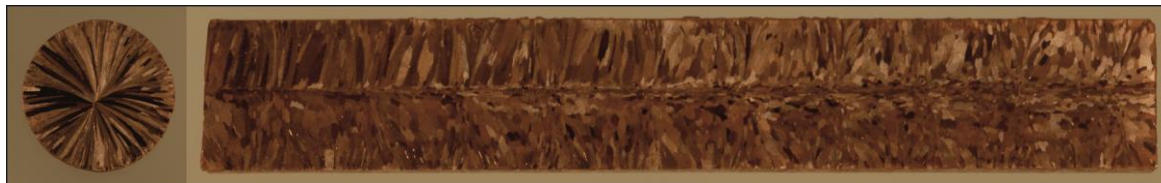
Rys. 9.1.20. Makrostruktura przekroju poprzecznego i wzdłużnego pręta z miedzi w gatunku Cu-OFE uzyskanego w procesie ciągłego odlewania w warunkach przemysłowych na instalacji Rautomead przy prędkości odlewania 4,0 m/min. oraz przy przepływie wody chłodzącej krystalizator 60 l/min.
