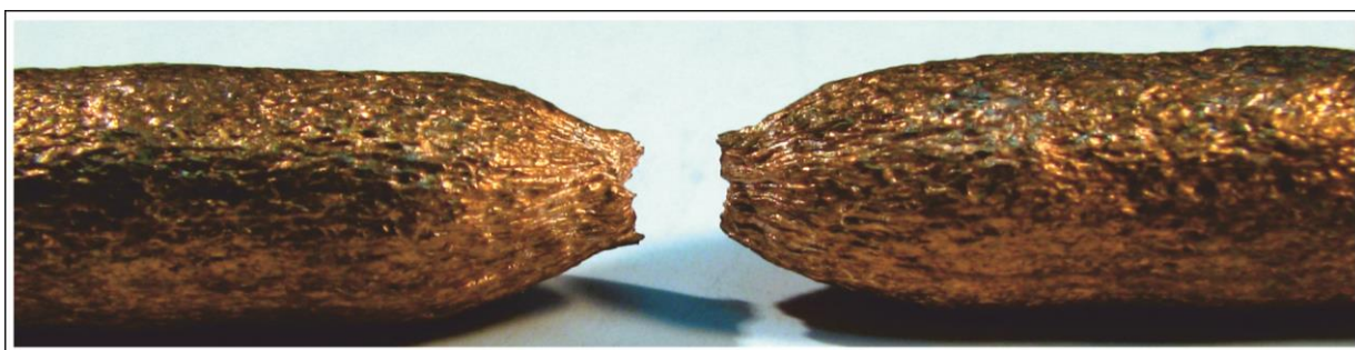
Rys. 9.1.48. Powierzchnia próbki pręta z miedzi w gatunku Cu-OFE z linii Upcast otrzymanego przy prędkości odlewania 4,0 m/min. po statycznej próbie rozciągania
