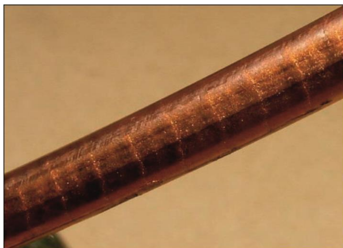
Rys. 9.1.21. Zewnętrzna powierzchnia pręta z miedzi beztlenowej w gatunku Cu-OFE uzyskanego w procesie ciągłego odlewania metodą Upcast
