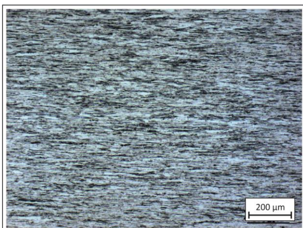
Rys. 9.2.34. Mikrostruktura przekroju wzdłużnego drutu o średnicy 3,2 mm otrzymanego z materiału wsadowego z miedzi w gatunku Cu-ETP z linii Contirod. Mikroskop świetlny
