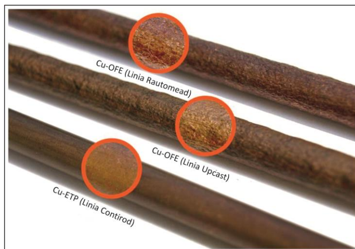
Rys. 9.3.60. Morfologia powierzchni walcówki z miedzi w gatunku Cu-ETP z linii Contirod oraz prętów z miedzi beztlenowej z linii Upcast i Rautomead po statycznej próbie rozciągania
