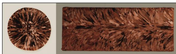
Rys. 9.1.9. Makrostruktura przekroju poprzecznego i wzdłużnego pręta z miedzi w gatunku Cu-OFE uzyskanego w procesie ciągłego odlewania w warunkach przemysłowych na instalacji Upcast przy prędkości odlewania 1,0 m/min. oraz przy przepływie wody chłodzącej krystalizator 50 l/min.
