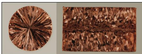
Rys. 9.1.17. Makrostruktura przekroju poprzecznego i wzdłużnego pręta z miedzi w gatunku Cu-OFE uzyskanego w procesie ciągłego odlewania w warunkach przemysłowych na instalacji Upcast przy prędkości odlewania 4,0 m/min. oraz przy przepływie wody chłodzącej krystalizator 40 l/min.
