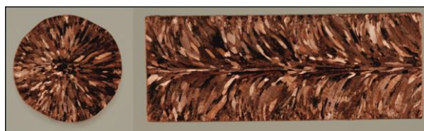
Rys. 9.1.10. Makrostruktura przekroju poprzecznego i wzdłużnego pręta z miedzi w gatunku Cu-OFE uzyskanego w procesie ciągłego odlewania w warunkach przemysłowych na instalacji Upcast przy prędkości odlewania 1,0 m/min. oraz przy przepływie wody chłodzącej krystalizator 60 l/min.
