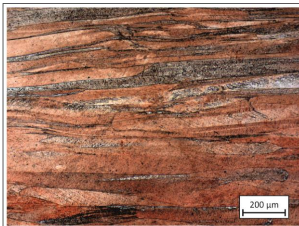
Rys. 9.2.33. Mikrostruktura przekroju wzdłużnego drutu o średnicy 3,7 mm otrzymanego z materiału wsadowego z miedzi w gatunku Cu-OFE z linii Upcast (prędkość odlewania 4,0 m/min., wydatek wody chłodzącej krystalizator 60 l/min). Mikroskop świetlny
