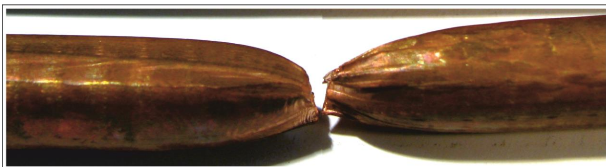
Rys. 9.1.50. Powierzchnia próbki pręta z miedzi w gatunku Cu-OFE z linii DCC-AGH otrzymanego przy prędkości 0,006 m/min. po statycznej próbie rozciągania
