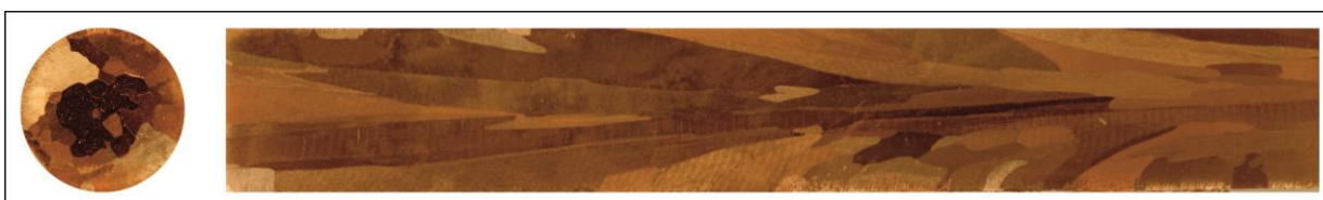
Rys. 9.1.6. Makrostruktura przekroju poprzecznego i wzdłużnego pręta z miedzi w gatunku Cu-OFE uzyskanego w procesie ciągłego odlewania w warunkach laboratoryjnych na instalacji DCC-AGH przy prędkości odlewania 0,2 m/min. oraz przy przepływie wody chłodzącej na poziomie 0,5 l/min. w układzie pierwotnym i 1,0 l/min. w układzie wtórnym.
