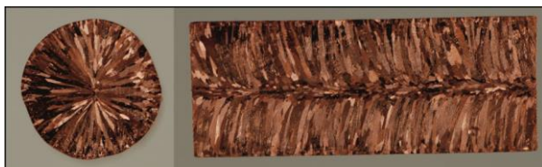
Rys. 9.1.13. Makrostruktura przekroju poprzecznego i wzdłużnego pręta z miedzi w gatunku Cu-OFE uzyskanego w procesie ciągłego odlewania w warunkach przemysłowych na instalacji Upcast przy prędkości odlewania 2,0 m/min. oraz przy przepływie wody chłodzącej krystalizator 60 l/min.
