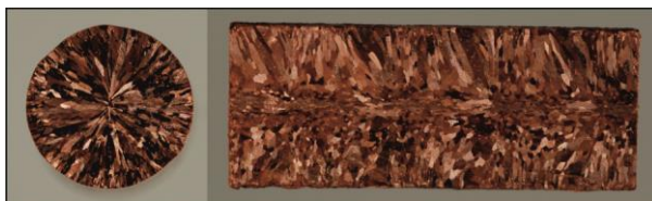
Rys. 9.1.12. Makrostruktura przekroju poprzecznego i wzdłużnego pręta z miedzi w gatunku Cu-OFE uzyskanego w procesie ciągłego odlewania w warunkach przemysłowych na instalacji Upcast przy prędkości odlewania 2,0 m/min. oraz przy przepływie wody chłodzącej krystalizator 50 l/min.
