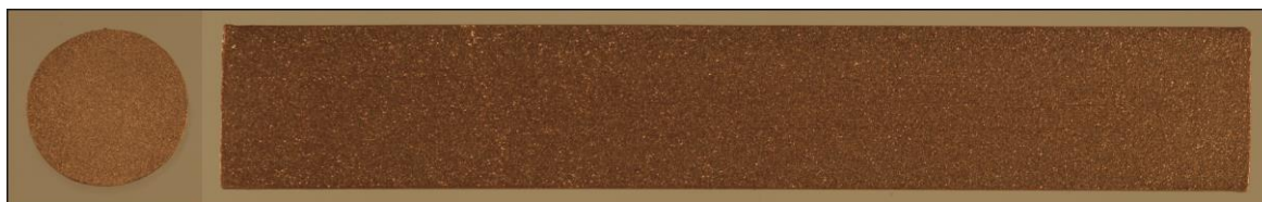
Rys. 9.1.22. Makrostruktura przekroju poprzecznego i wzdłużnego walcówki z miedzi w gatunku Cu-ETP uzyskanej w procesie przeróbki plastycznej na gorąco w warunkach przemysłowych na instalacji Contirod przy prędkości walcowania 30 m/s.
