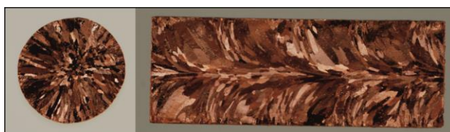
Rys. 9.1.8. Makrostruktura przekroju poprzecznego i wzdłużnego pręta z miedzi w gatunku Cu-OFE uzyskanego w procesie ciągłego odlewania w warunkach przemysłowych na instalacji Upcast przy prędkości odlewania 1,0 m/min. oraz przy przepływie wody chłodzącej krystalizator 40 l/min.
