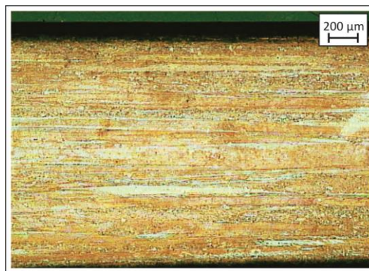
Rys. 9.3.123. Mikrostruktura przekroju wzdłużnego drutu o średnicy 2,5 mm otrzymanego z pręta z miedzi w gatunku Cu-OFE z linii Upcast (obróbka cieplna w temperaturze 900 °C w czasie 1 h) po wygrzewaniu w teście jednogodzinnym w temperaturze 190 °C. Mikroskop świetlny, powiększenie \times 5
