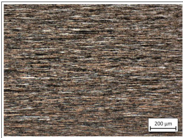
Rys. 9.2.36. Mikrostruktura przekroju wzdłużnego drutu o średnicy 2.7 mm otrzymanego z materiału wsadowego z miedzi w gatunku Cu-ETP z linii Contirod. Mikroskop świetlny
