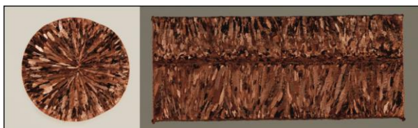
Rys. 9.1.15. Makrostruktura przekroju poprzecznego i wzdłużnego pręta z miedzi w gatunku Cu-OFE uzyskanego w procesie ciągłego odlewania w warunkach przemysłowych na instalacji Upcast przy prędkości odlewania 3,0 m/min. oraz przy przepływie wody chłodzącej krystalizator 50 l/min.
