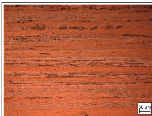
Rys. 9.3.16. Mikrostruktura przekroju wzdłużnego drutu o średnicy 2,5 mm z miedzi w gatunku Cu-OFE po procesie wygrzewania w temperaturze 160 °C w czasie 1 h
