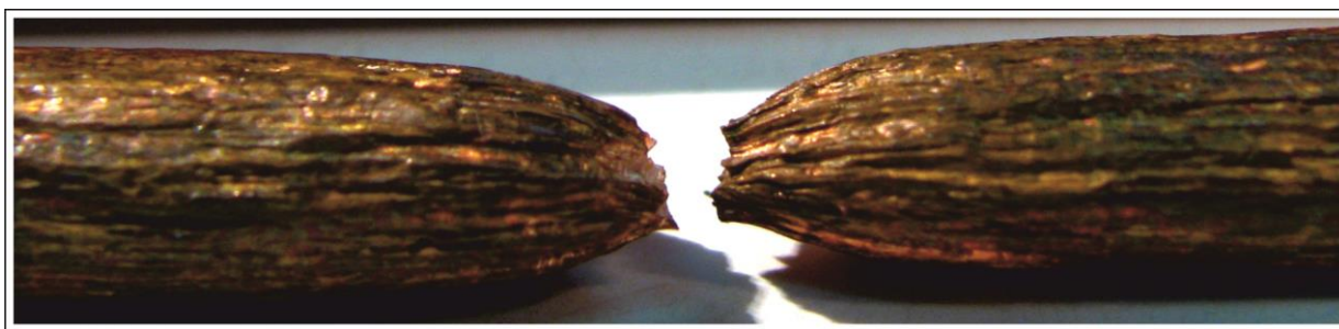
Rys. 9.1.49. Powierzchnia próbki pręta z miedzi w gatunku Cu-OFE z linii Upcast otrzymanego przy prędkości odlewania 0,5 m/min. po statycznej próbie rozciągania
