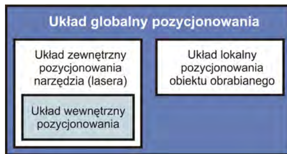
Rys. 43. Układy pozycjonowania laserowego urządzenia do obróbki szkła
