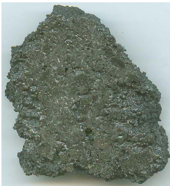
Fig. 4. Żużel, próbka 5b (hałda świeża).
