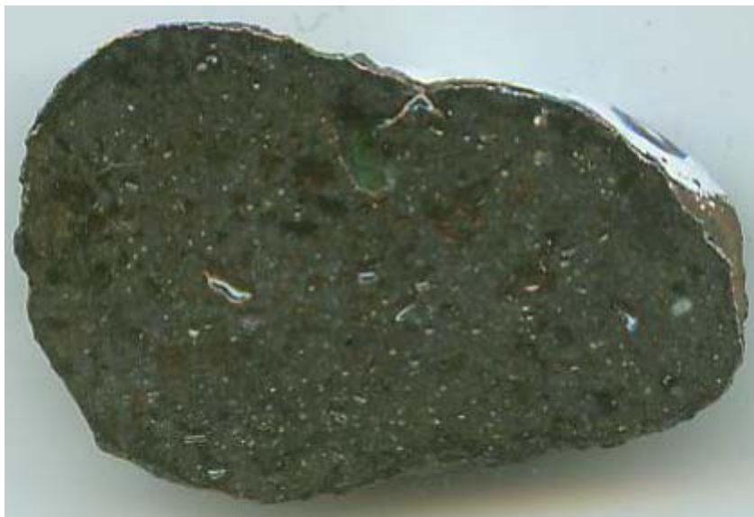
Fig. 7. Żużel, próbka 8b (hałda świeża).
