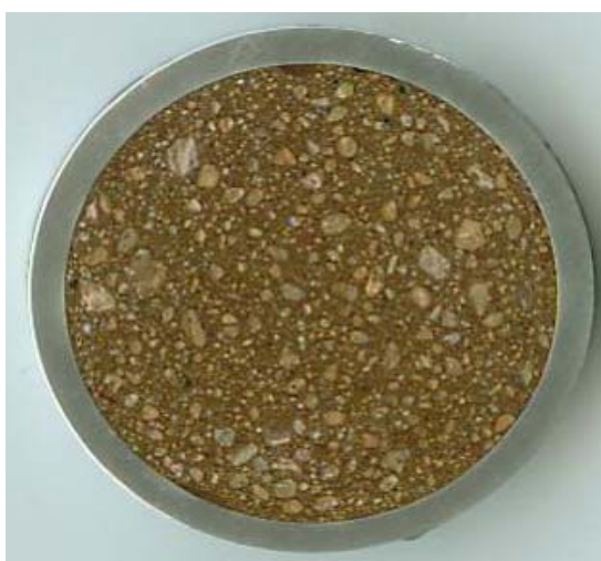
Fig. 17. Szlam Pb, próbka 20 (z węzła mycia gazu prażalniczego). Anglezyt, niewiele tlenków żelaza.
