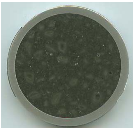
Fig. 15. Odpad flotacyjny, próbka 18 (staw osadnikowy). Piryt, markasyt, sfaleryt, węglany.
