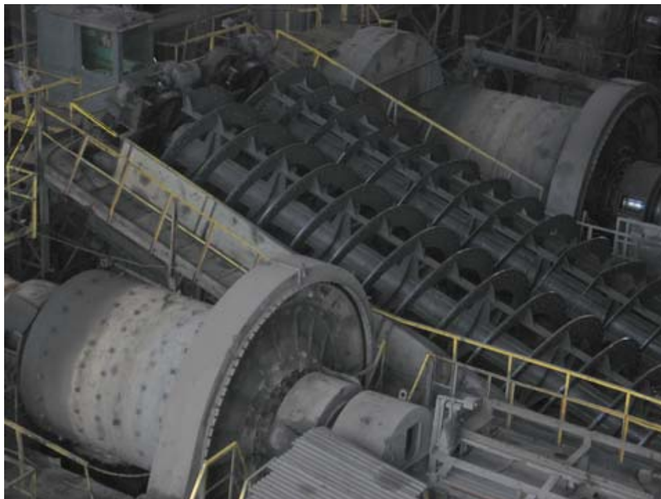
Fig. 1. Mielenie i klasyfikacja rudy; młyn kulowy i prętowy (fot. B. Rajchel).
