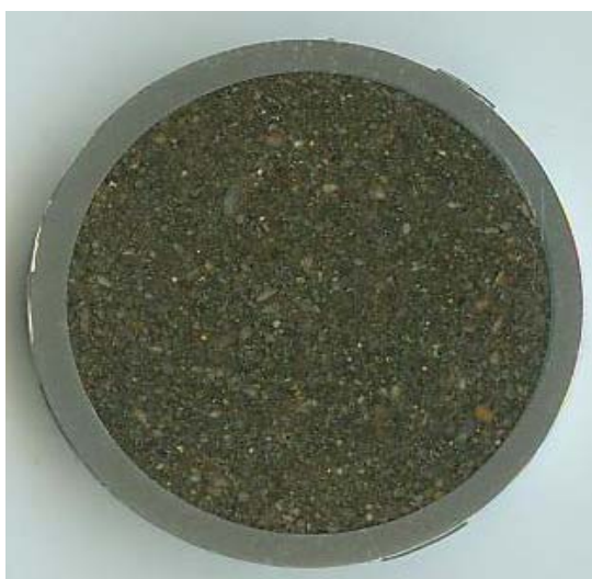
Fig. 16. Odpad flotacyjny, próbka 19 (staw osadnikowy). Niewielkie ziarna pirotynu, niewielkie ziarna żelaza, willemit, getyt i limonit, kwarc, dużo węglanów, piryt, markasyt.
