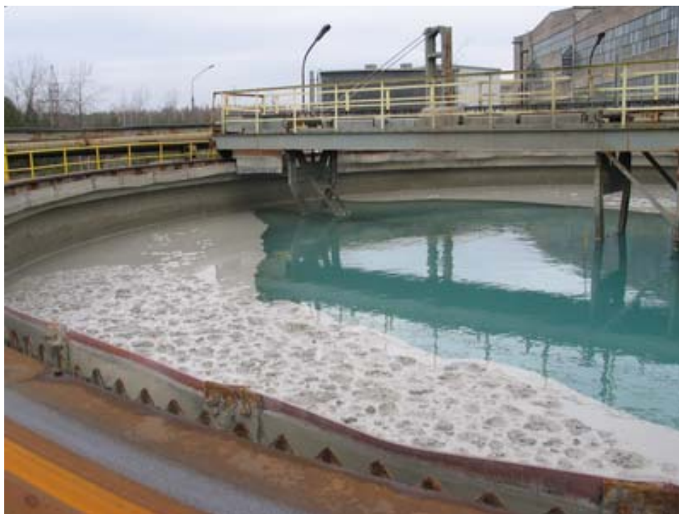
Fig. 3. Zagęszczanie koncentratów (fot. B. Rajchel).
