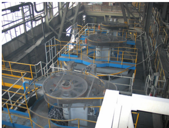
Fig. 15. Proces flotacji głównej blendy cynkowej (fot. B. Rajchel).
