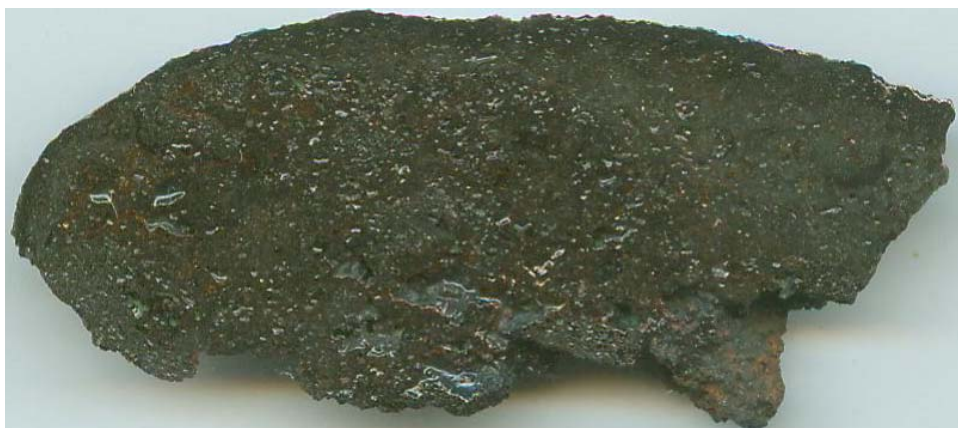
Fig. 3. Żużel, próbka 4b (hałda świeża).
