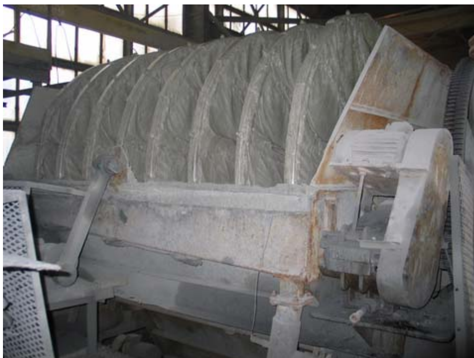
Fig. 4. Filtrowanie koncentratów; filtr tarczowy (fot. B. Rajchel).
