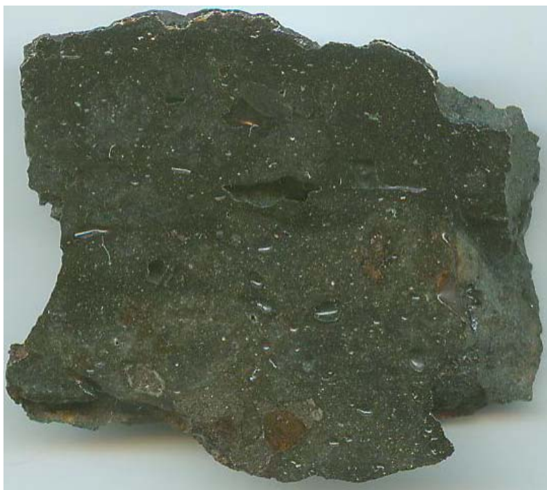
Fig. 2. Żużel, próbka 3b (hałda świeża).
