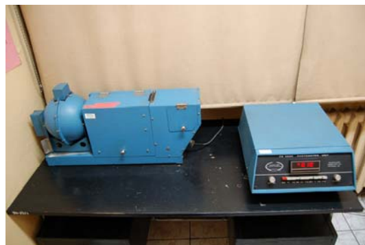
Fot.2 Spektrofotometr PG 5500
