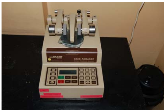
Fot.1 Urządzenie Taber Abraser
