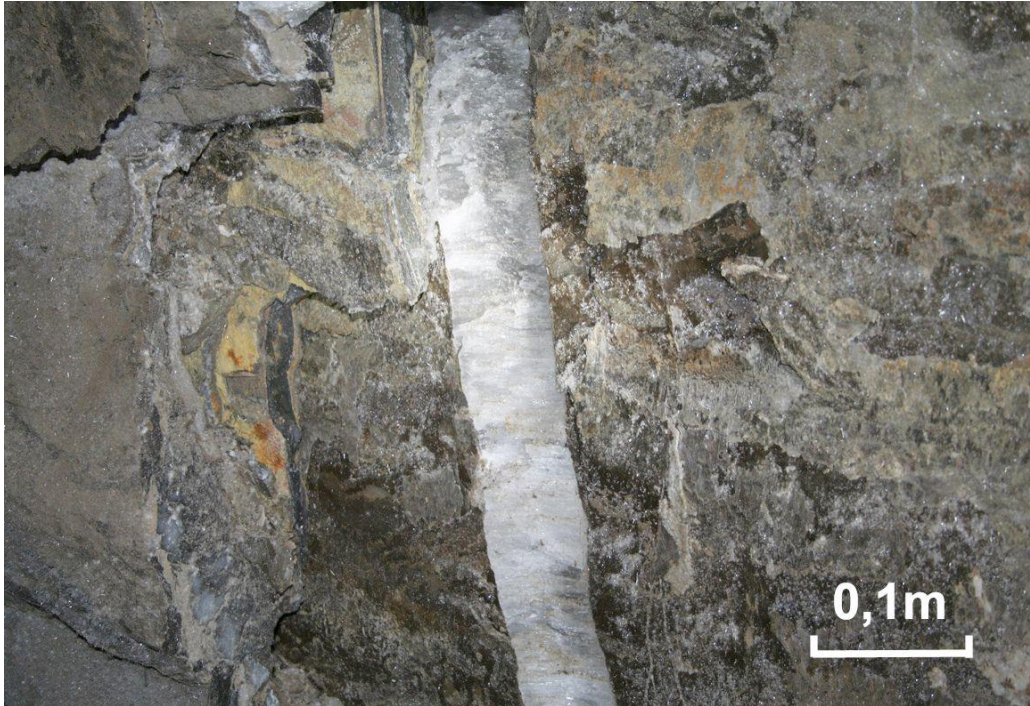
Fot. 5.2.5 Żyła soli włóknistej o prostych krawędziach, podłużnia Sienkiewicz, poz. Sienkiewicz (CIII), K.S. Bochnia.
