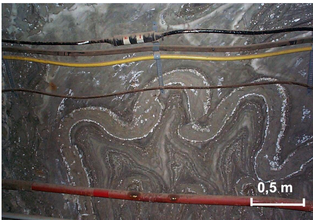
Fot. 5.4.6 Zafałdowane przerosty iłowe, objazd szybu Campi, poz. August (CI), K.S. Bochnia
