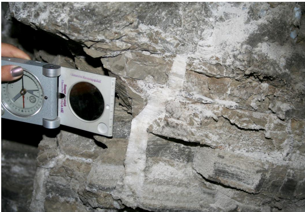
Fot. 5.2.7 Żyła soli włóknistej, której włókna są skręcone, podłużnia Sienkiewicz, poz. Sienkiewicz (CIII), K.S. Bochnia.
