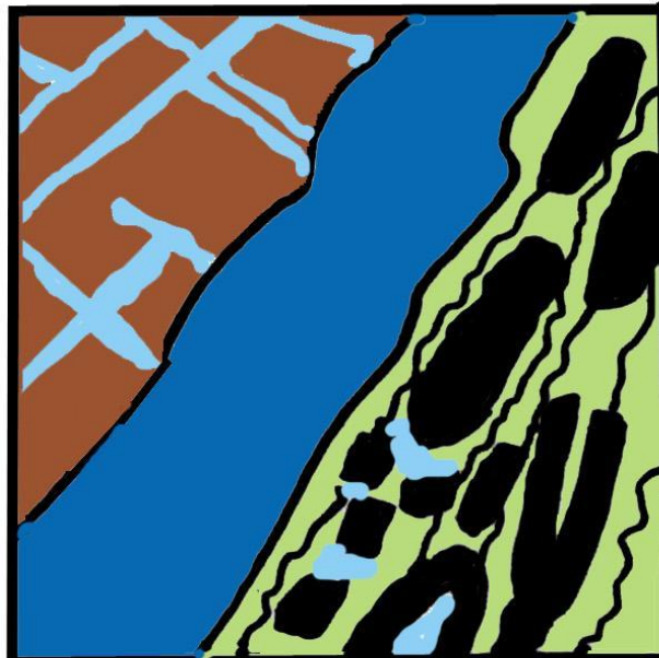
Rys. 10.1.1 Zaangażowanie tektoniczne utworów, poprzecznik w pobliżu pp 3215, poziom C5, K.S. Bochnia, lokalizacja patrz rys. 10.1.18, odsłonięcie 1.
