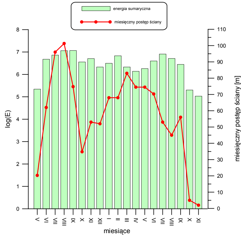
Rys. 6.46. Energia sumaryczna wstrząsów górotworu zarejestrowanych w poszczególnych miesiącach eksploatacji pokładu 703/1 ścianą V-E1
