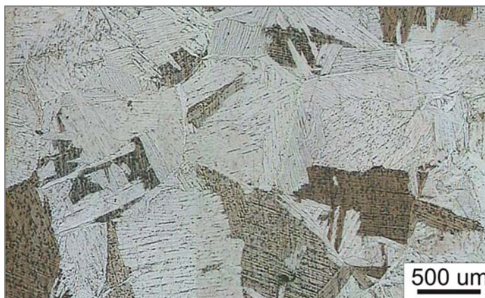
Rys. 43. Mikrostruktura tytanu technicznego po azotowaniu jarzeniowym w temperaturze 900°C, LM
