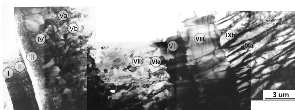
Rys. 76. Mikrostruktura warstwy niklowo-fosforowej, wytworzonej na stopie Ti6Al7Nb w temperaturze 800°C z zaznaczonymi miejscami, w których wykonano ilościową analizę punktową EDS, cienka folia TEM z przekroju poprzecznego
