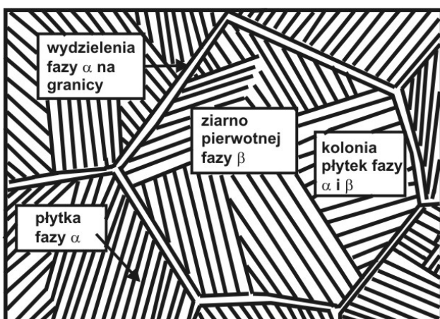
Rys. 7. Schemat dwufazowej ( \alpha+\beta ), płytkowej struktury gruboziarnistej stopów tytanu, wg [105]
